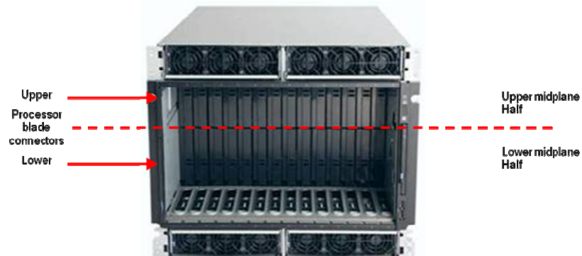
Fig. 3.17 Plano Superior e Inferior del Midplane en el Chasis BladeCenter H Fuente: Introduction to IBM BladeCenter® H, IBM Corporation
