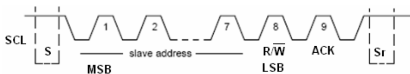
Figura 1.38: Formato de trama enviada por el bus I2C 54
