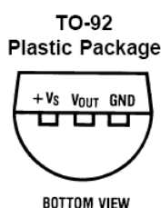
Figura 2.10: Distribución de pines del sensor LM35DZ 96
