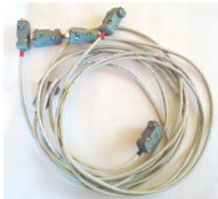
Figura 3.2: Bus CAN y bus serial para conexión con la PC
