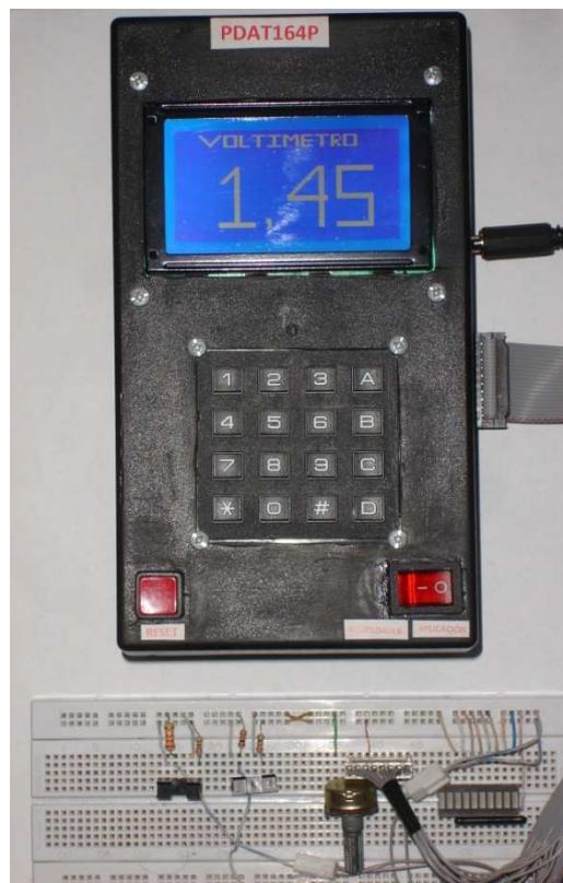
Fig. 4-16 Ejemplo 2 de la práctica voltímetro digital en el PDAT164P
