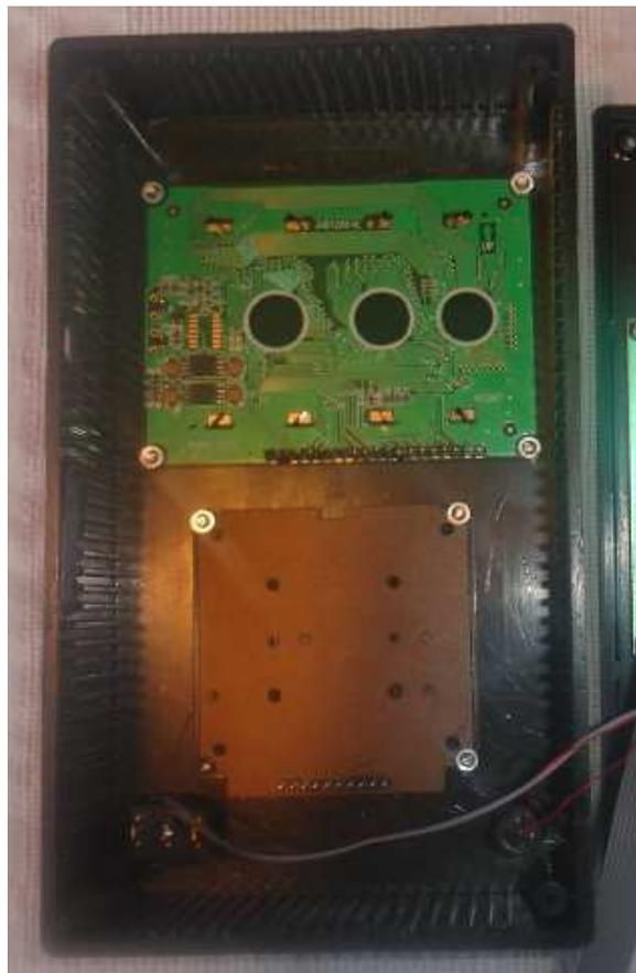
**Fig. 2-14** Montaje de la GLCD y el teclado 4x4 en la parte delantera de la caja
