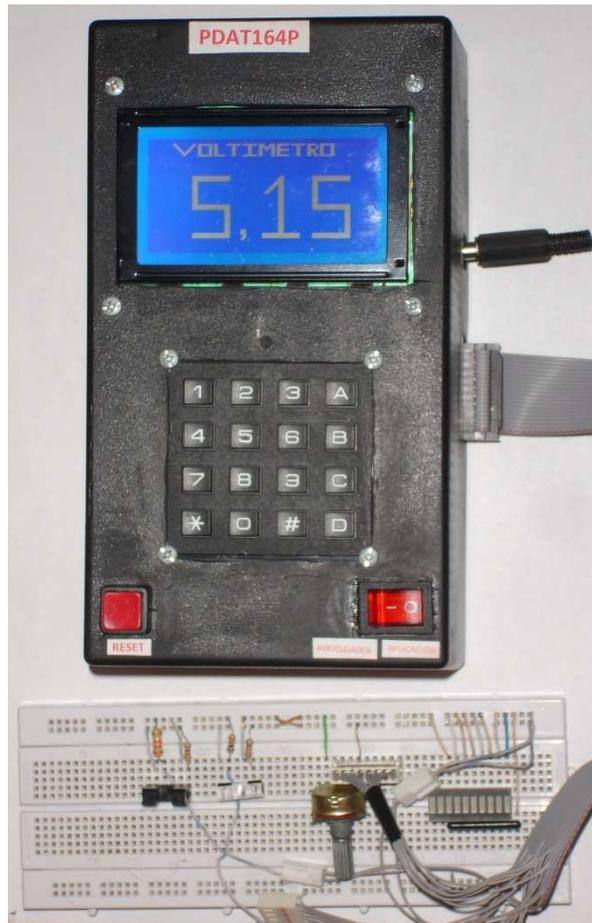
**Fig. 4-17** Ejemplo 3 de la práctica voltímetro digital en el PDAT164P
