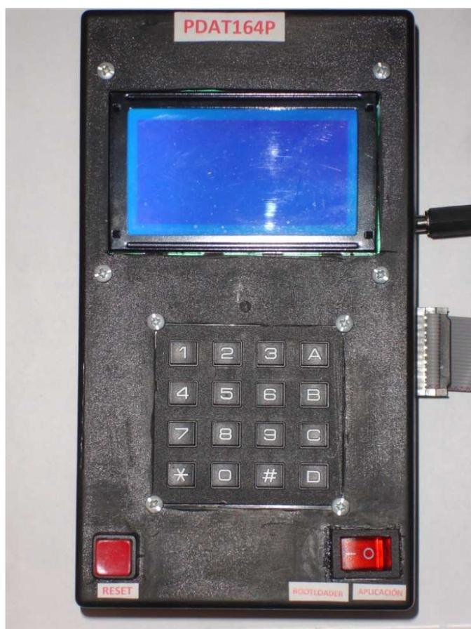
**Fig. 4-10** PDAT164P en la posición de Bootloader
