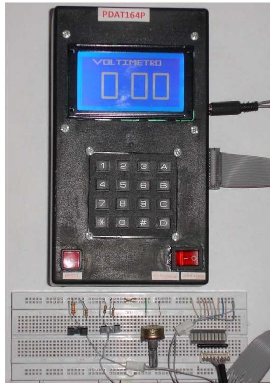
Fig. 4-15 Ejemplo 1 de la práctica voltímetro digital en el PDAT164P
