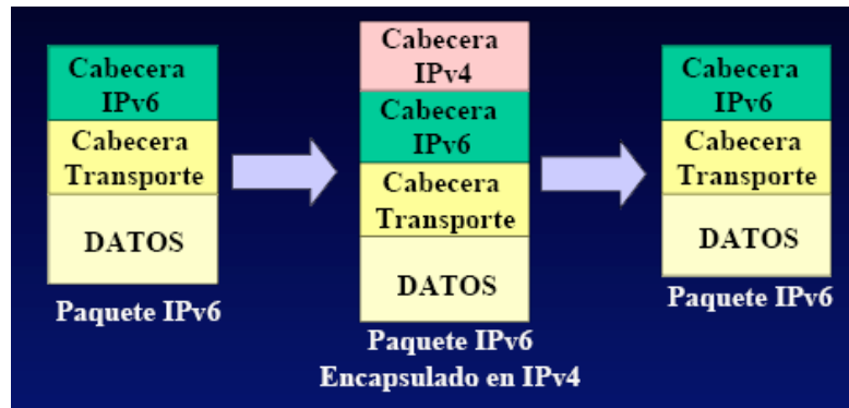
Figura 4.5 Mecanismo de túnel IPv6/IPv4 [44]
