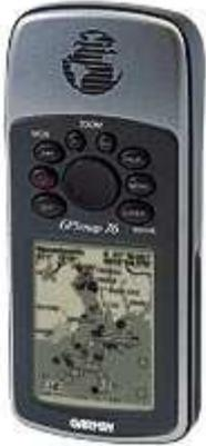
Esta unidad cuenta con una antena interna helicoidal para obtener una excelente recepción con una precisión de 3 a 16 Mt.
