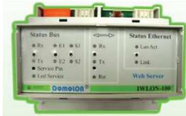
*Figura 4.13 Servidor Web IWLON-100X/V3*
