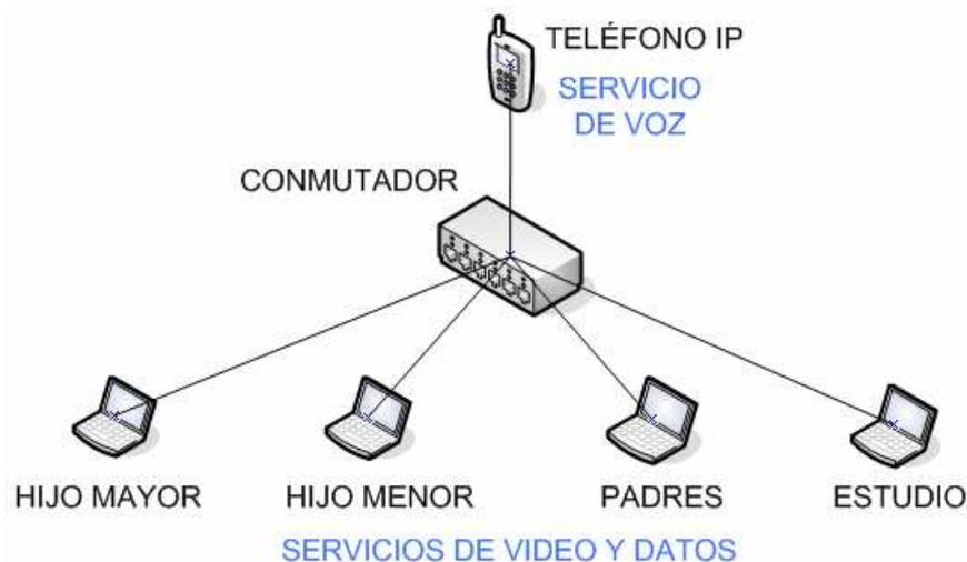
*Figura 4.4 Esquema de la red de datos*
