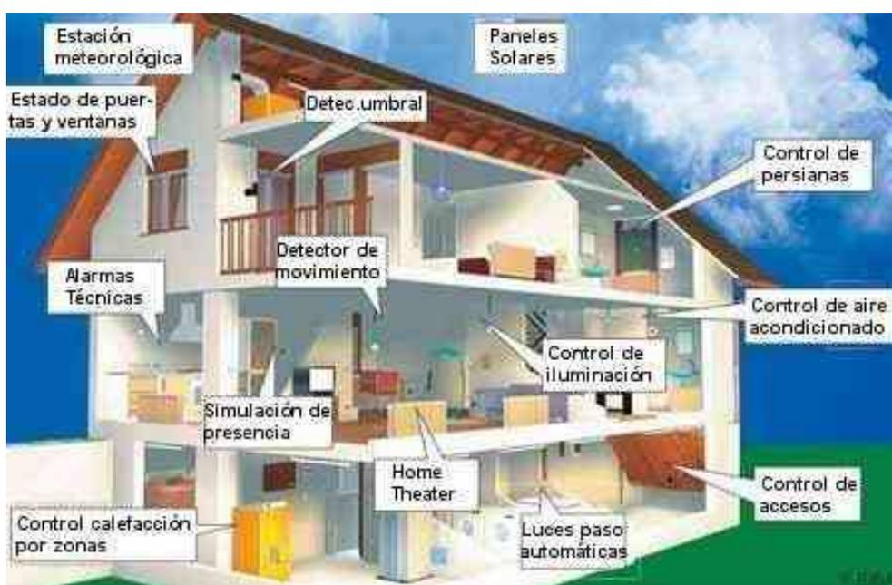
*Figura 1.2 Vivienda domótica típica<sup>1</sup>*
