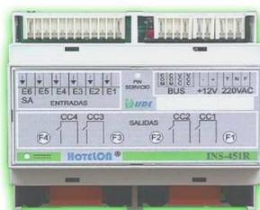
*Figura 4.11 Nodo de Control de habitación INS-451X/V3*
