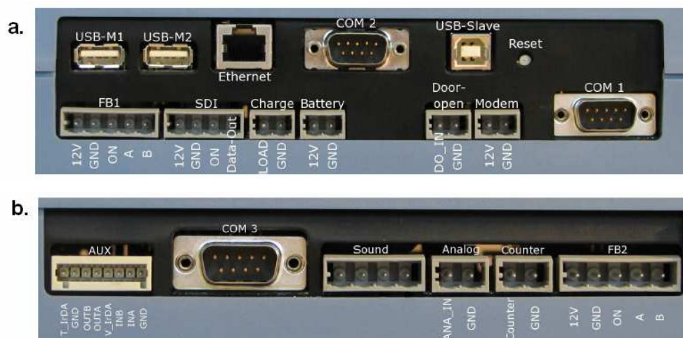
Figura 3.6 a) Vista Frontal del Tablero de Puertos del Datalogger b) Vista Posterior del Tablero de Puertos del Datalogger [52]
