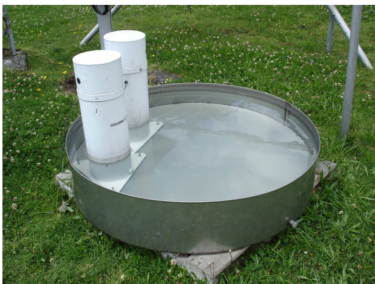
Figura 1.9 Tanque de Evaporización
