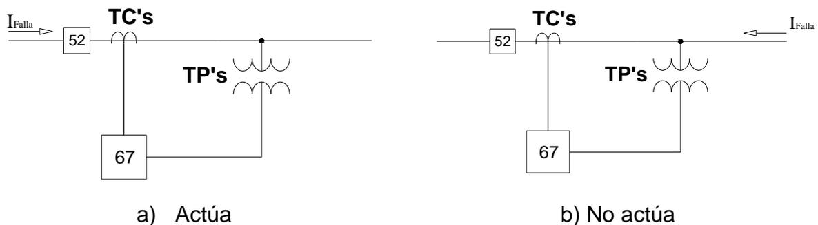
Figura 2.16. Protección direccional
