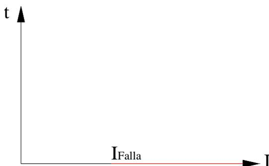
**Figura 2.6.** Característica instantánea de los relés de protección de sobrecorriente.
