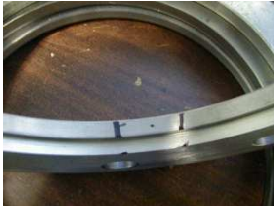
Figura 1.1. Cavidad por contracción encontrada en una brida de 6 Plg.
