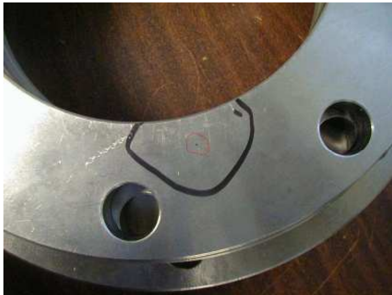
Figura 1.2. Micro porosidad encontrada en una brida de 6 Plg.
