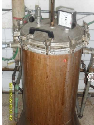
Medidor de la temperatura del autoclave y termocupla
