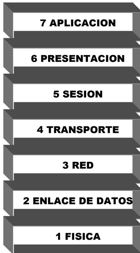
Figura 72 Modelo de referencia OSI.
