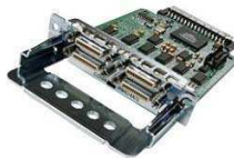
Figura 4-34: Módulo Cisco 4 puertos seriales
