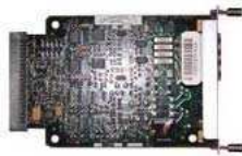
Figura 4-41: Módulo Cisco 2 puertos FXO
