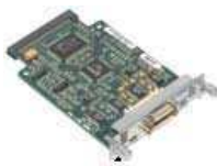
Figura 4-33: Módulo Cisco 2 puertos seriales
