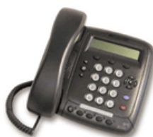
Figura 4-18: Teléfono Básico con Parlante 3COM 3101
