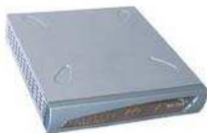
Figura 4-15: Gateway 3COM VCX 7111 8 puertos FXO
