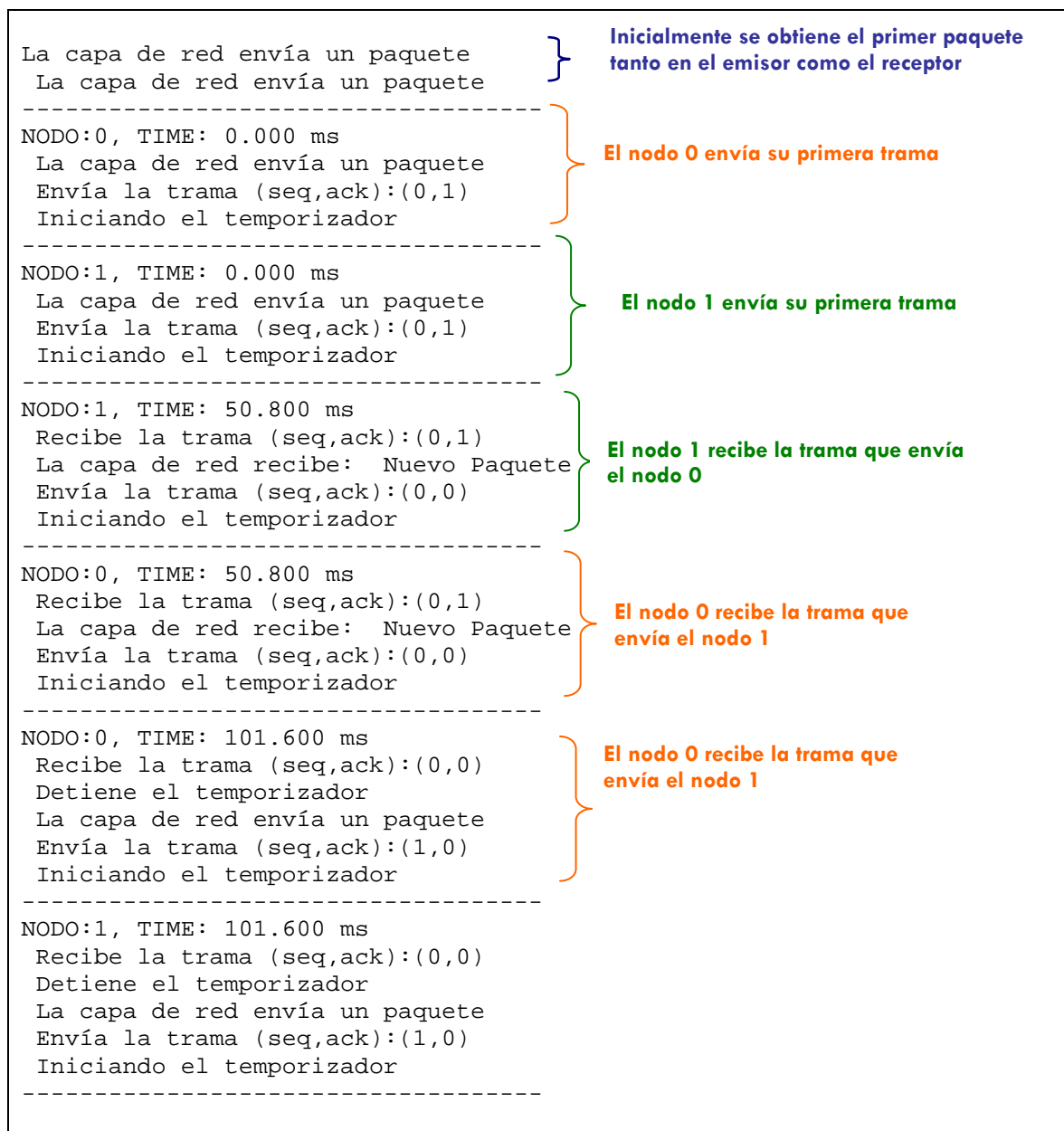
Figura 3. 31 Resultados impresos en pantalla obtenidos de la simulación del protocolo de “ventana corrediza de un bit” para el caso en el que los agentes A y B empieza con la transmisión simultáneamente.
