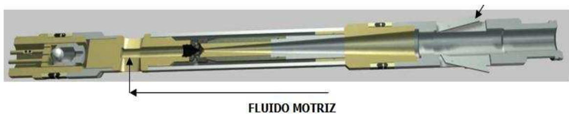
FIGURA 2.9 BOMBA JET DE INYECCIÓN REVERSA
