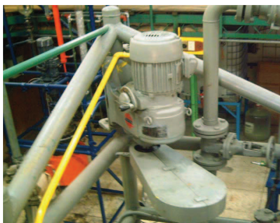
Figura 2.3 Motor de trifásico de inducción para la agitación
