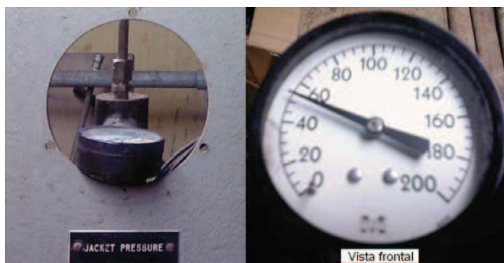
Figura 2.19 Manómetro para medir presión dentro de la camisa
