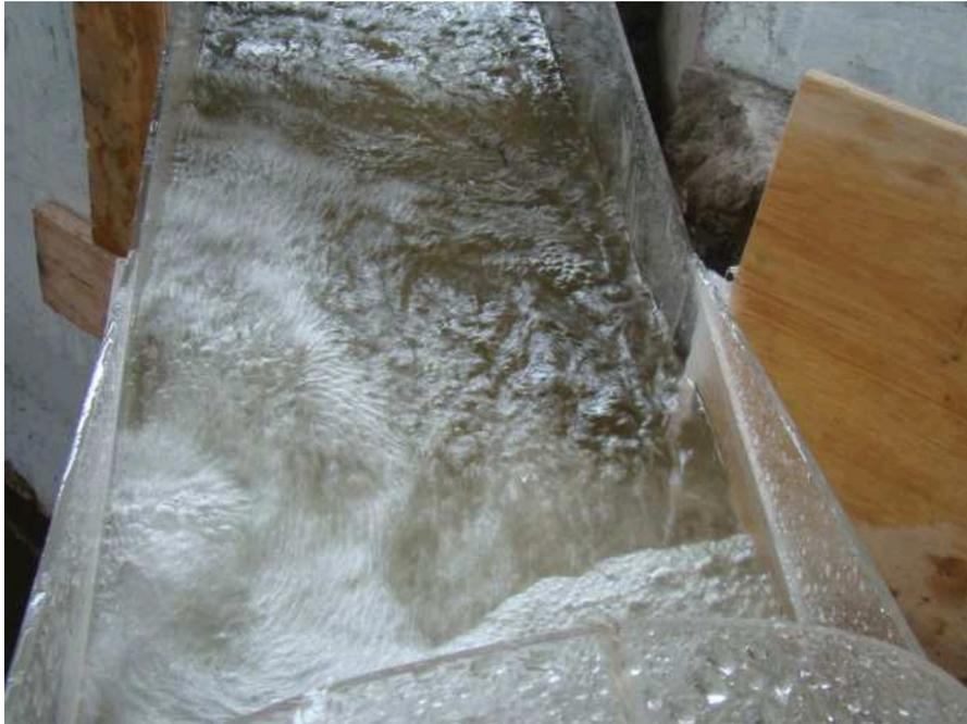
Fotografía No.60.- Vista aérea del funcionamiento del dissipador.  $Q=200 \text{ m}^3/\text{s}$  – Variante 2.
