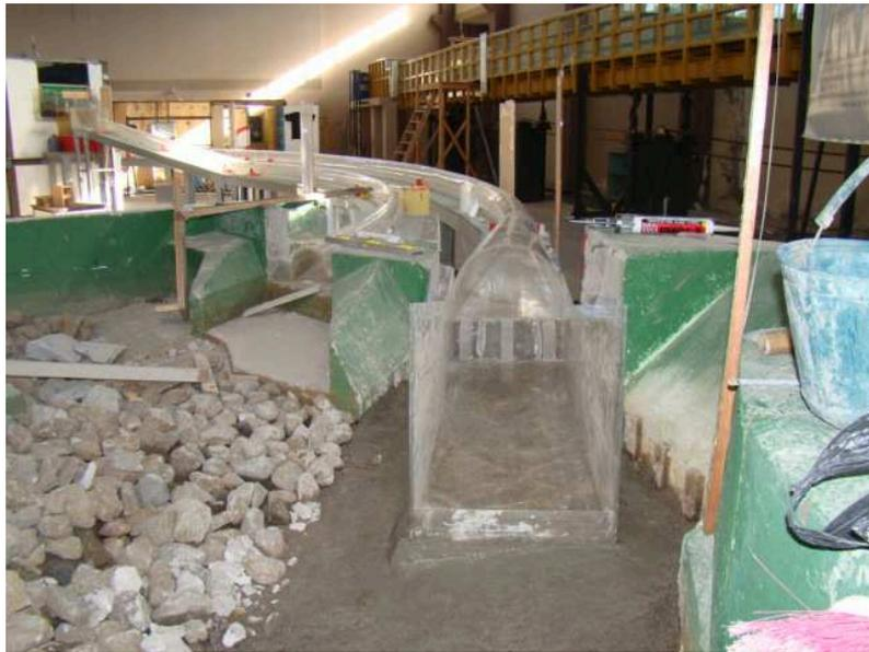
Fotografía No. 12.- Cuenco disipador tipo IV colocado inmediatamente aguas debajo de la transición.
