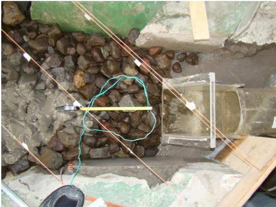
Fotografía No.86.- Cuenco de socavación producto de  $Q=100 \text{ m}^3/\text{s}$  – Variante 4
