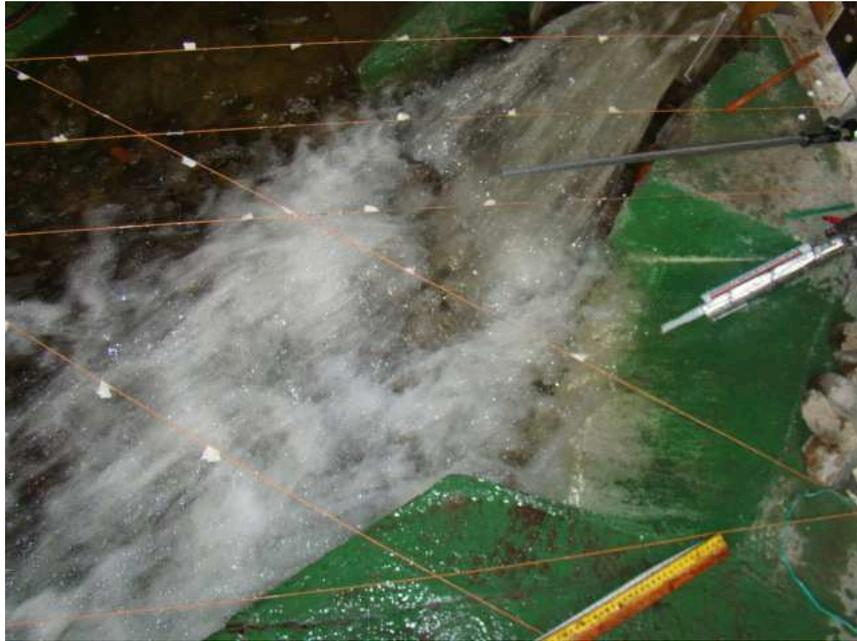
Fotografía No.85.- Funcionamiento del disipador y comportamiento del cuenco preexcavado para  $Q=1130$   $m^3/s$  – Variante 4
