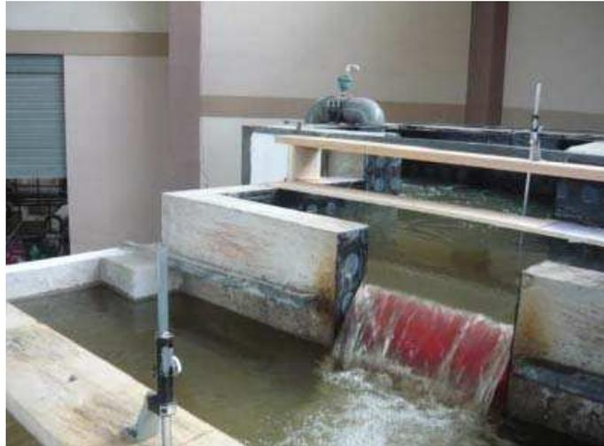
Fotografía No. 20.- Ubicación de vertedero en el tanque de entrada (inicio del modelo).
