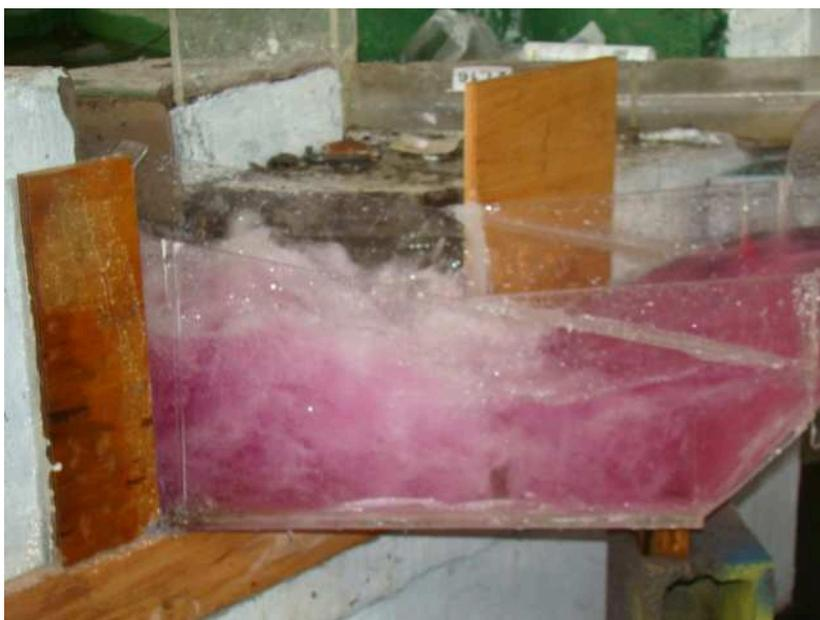
Fotografía No.57.- Vista lateral del escalón negativo del disipador.  $Q=800 \text{ m}^3/\text{s}$  – Variante 2.
