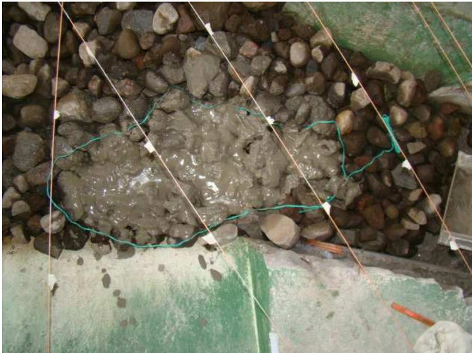
Fotografía No.88.- Cuenco de socavación producto de  $Q=500 \text{ m}^3/\text{s}$ ,  $Q=800 \text{ m}^3/\text{s}$  – Variante 4
