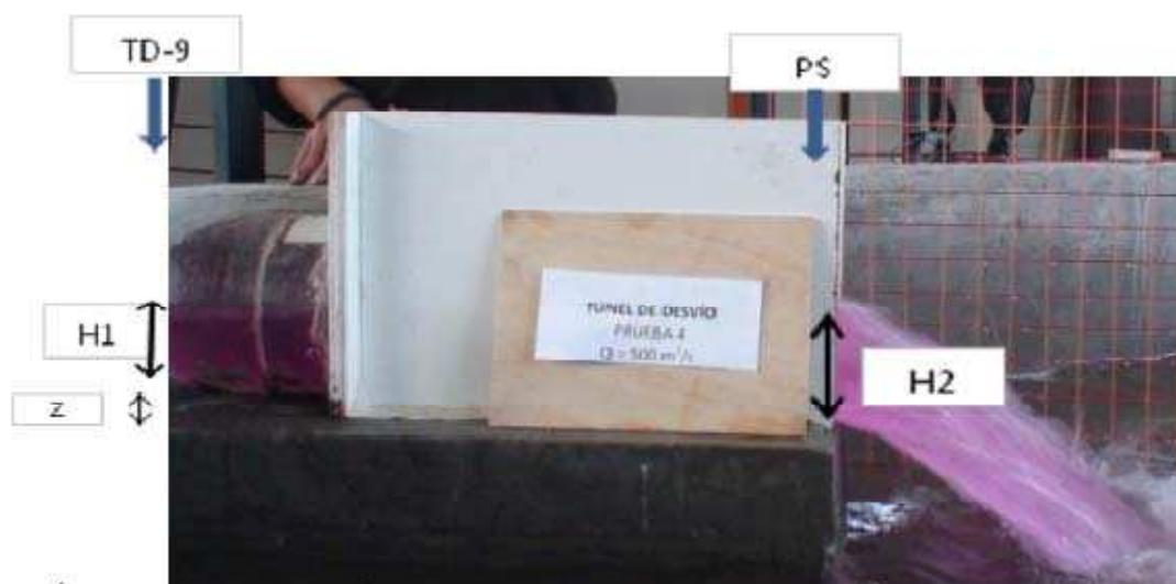
Fotografía No. 5.- Esquema con la ubicación general de las secciones transversales definidas para la comparación de las alturas de energía
