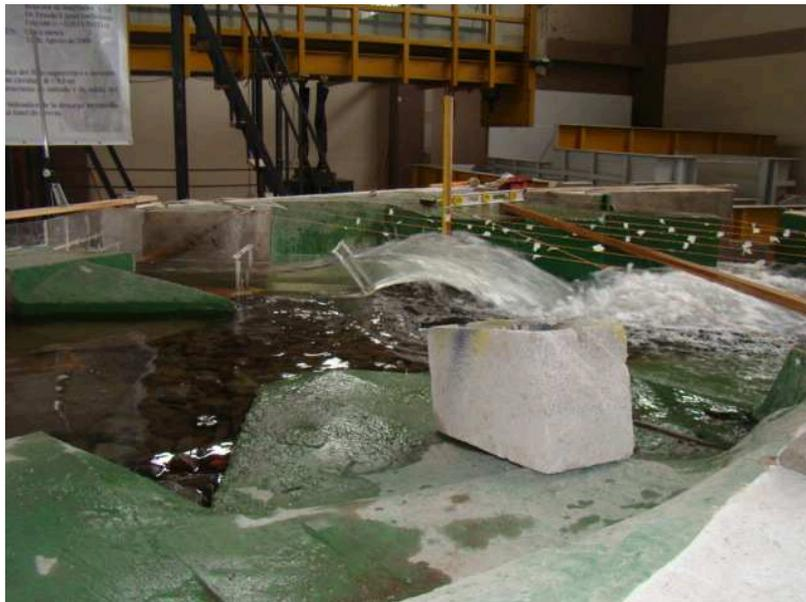
Fotografía No.73.- Vista lateral del funcionamiento de la tercera variación del salto en esquí.  $Q=1130 \text{ m}^3/\text{s}$  – Variante 3.
