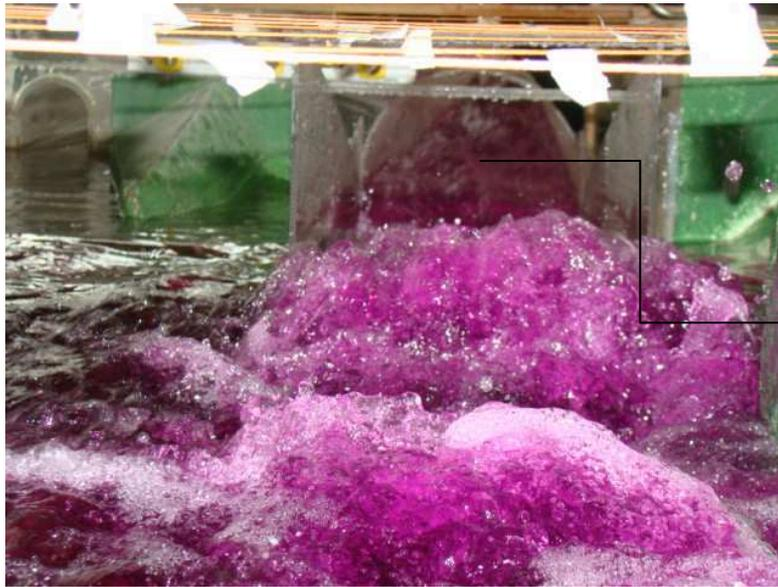
Onda cruzada debido a la influencia de la curvatura en planta del túnel de desvío.
