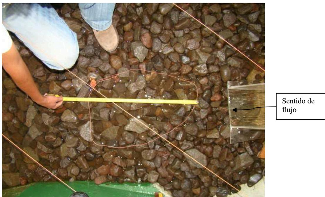
Fotografía No. 48.- Cuenco de socavación producto del caudal de funcionamiento límite  $Q=330\text{m}^3/\text{s}$  – Variante 2.
