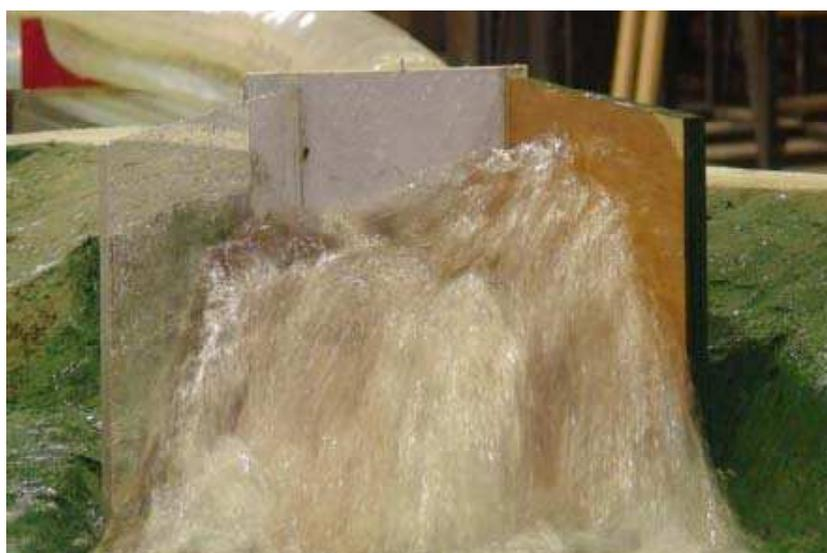
Fotografía No. 7.- Vista frontal del flujo de salida con funcionamiento del dissipador tipo Kumin con Caudal =  $900 \text{ m}^3/\text{s}$ .
