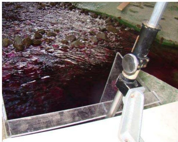
Fotografía No. 15.- Limnómetro empleado en la sección de la cubeta de disipación.
