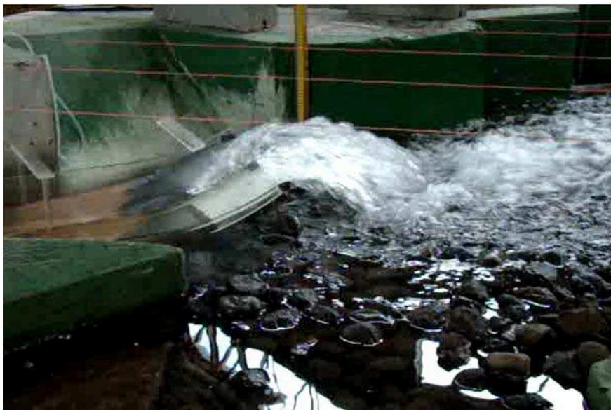
Fotografía No. 40.- Vista lateral del chorro producto del caudal de funcionamiento límite  $Q=330\text{m}^3/\text{s}$  – Variante 2.
