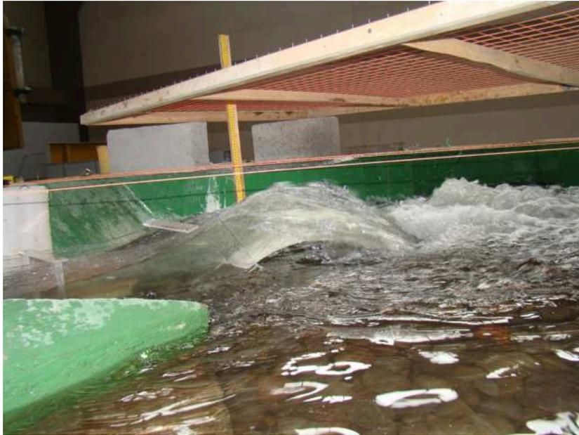
Fotografía No. 37.- Vista lateral del chorro producto de  $Q=1130\text{m}^3/\text{s}$  – Variante 2.
