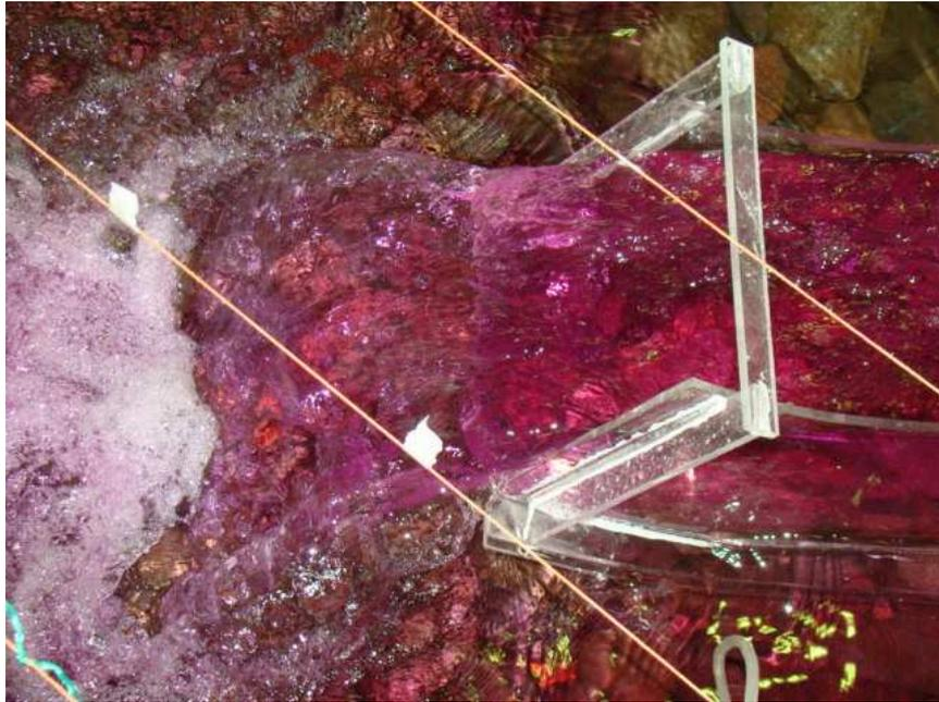
Fotografía No.66.- Vista lateral del funcionamiento de la tercera variación del salto en esquí.  $Q=200 \text{ m}^3/\text{s}$  – Variante 3.
