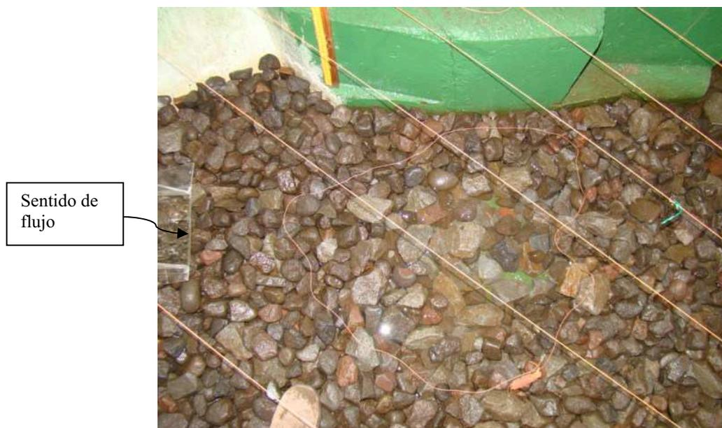
Fotografía No. 46.- Cuenco de socavación producto del caudal  $Q=800\text{m}^3/\text{s}$  – Variante 2.
