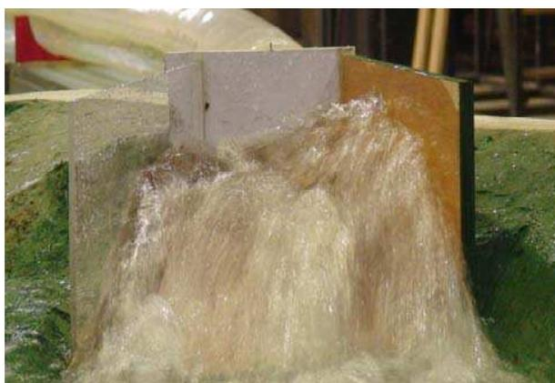
Fotografía No. 2.- Vista frontal del flujo de salida con funcionamiento del disipador tipo Kumin modificada con Caudal =  $900\text{ m}^3/\text{s}$ . Sin control aguas abajo
