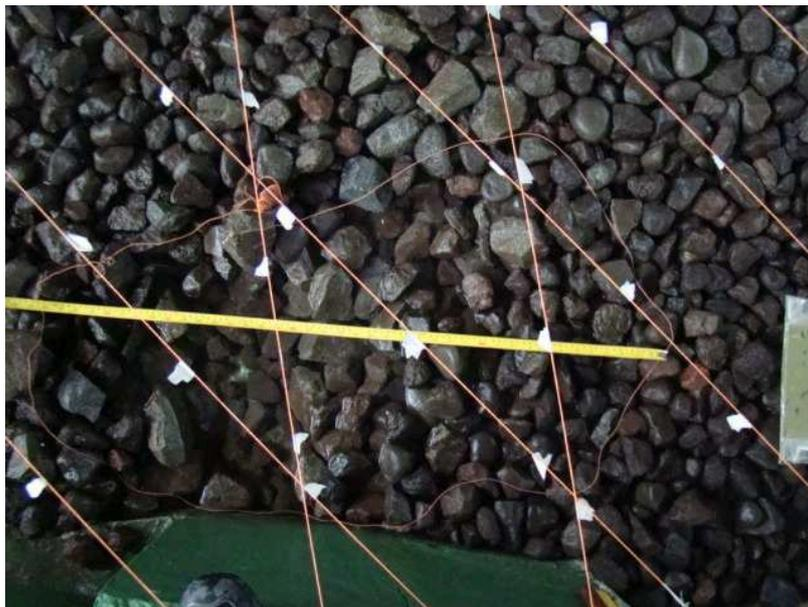
Fotografía No.75.- Cuenco de socavación producto de la alternativa 3.  $Q=800 \text{ m}^3/\text{s}$  – Variante 3.
