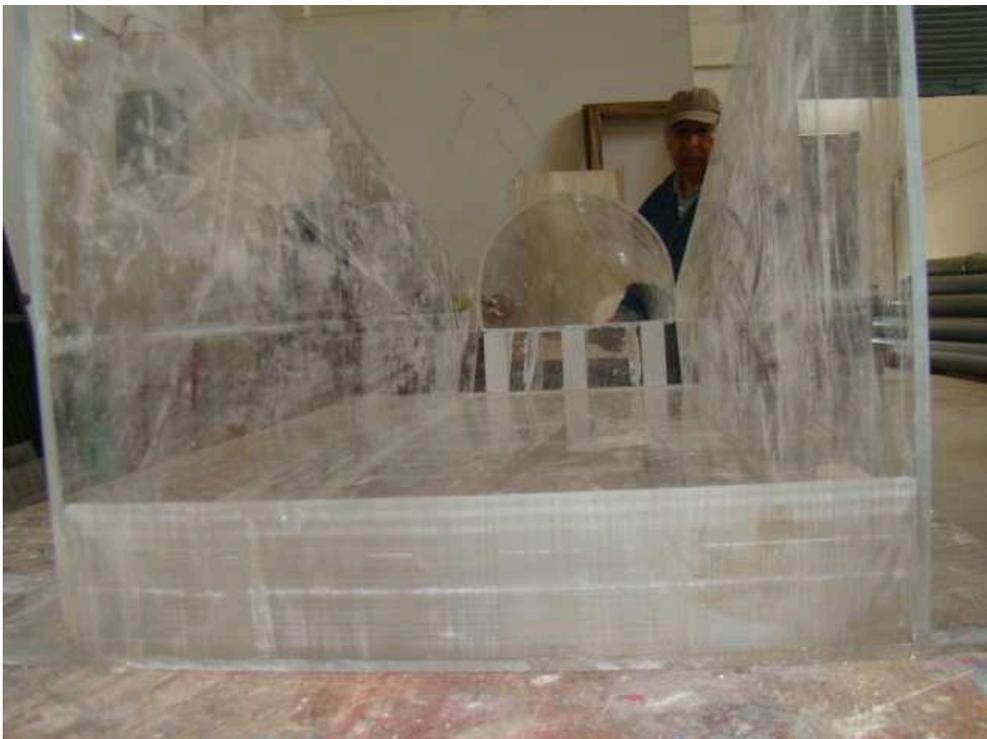
Fotografía No.10.- Vista frontal del cuenco disipador y la transición.
