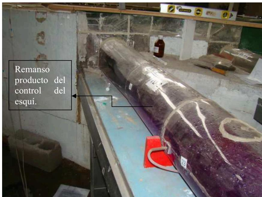
Fotografía No.65.- Vista del remanso producido por la altura del esquí.  $Q=100 \text{ m}^3/\text{s}$  – Variante 3.
