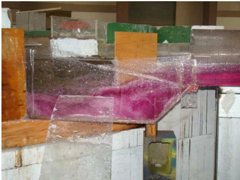
Fotografía No.55.- Vista lateral de la zona del escalón negativo de la cubeta modificada.  $Q=1130 \text{ m}^3/\text{s}$  – Variante 2.
