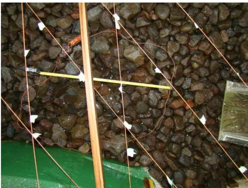
Fotografía No.76.- Cuenco de socavación producto de la alternativa 3.  $Q=500 \text{ m}^3/\text{s}$  – Variante 3.
