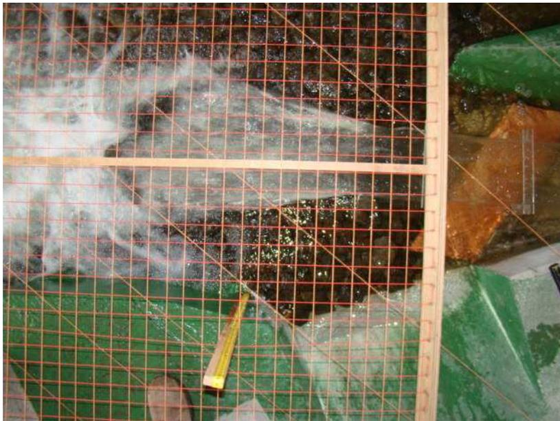
Fotografía No. 36.- Vista superior del chorro producto de  $Q=1130 \text{ m}^3/\text{s}$  – Variante 2.
