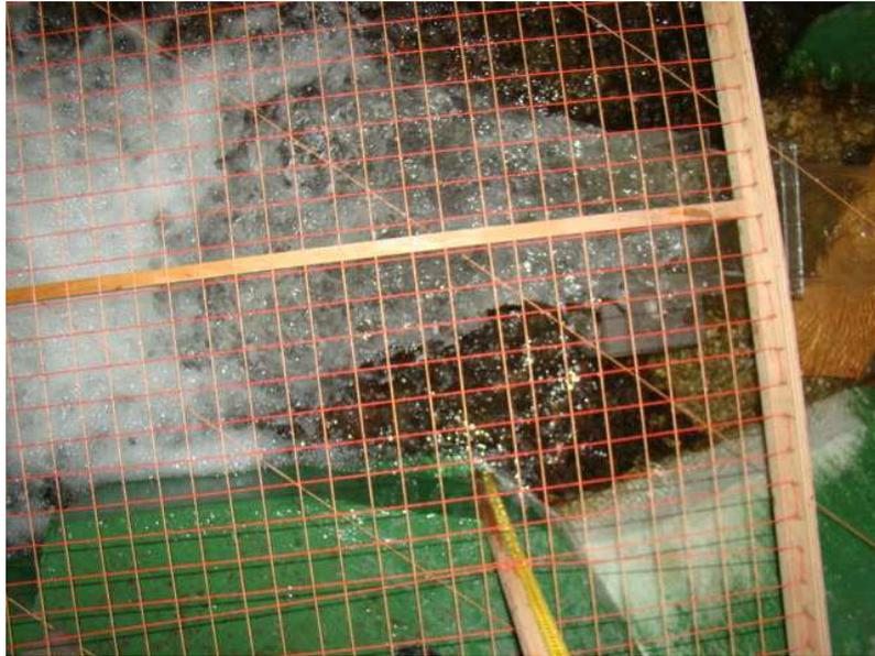
Fotografía No. 34.- Vista aérea del chorro producto del caudal límite de funcionamiento  $Q=1000\text{m}^3/\text{s}$  – Variante 1.
