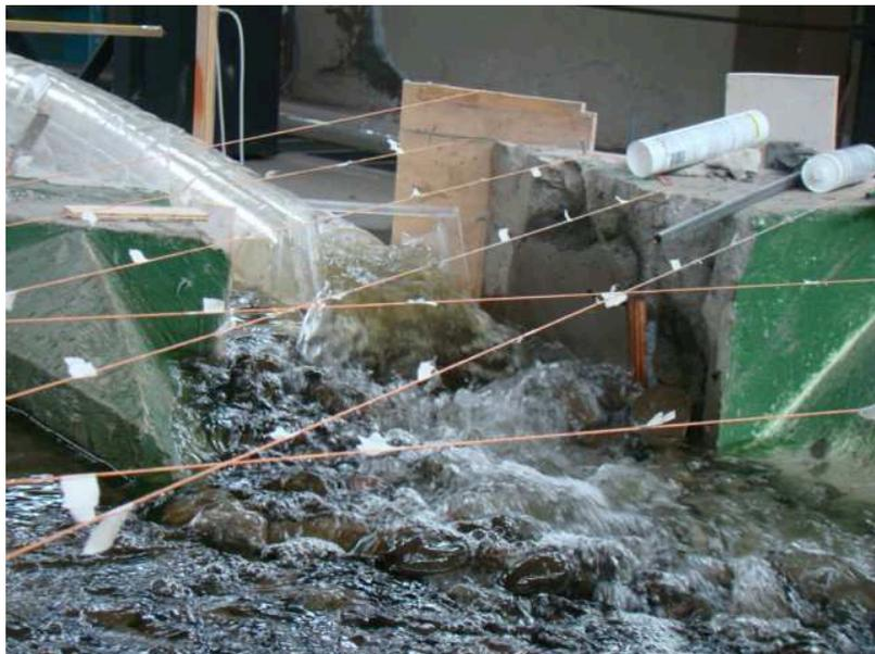
Fotografía No.82.- Funcionamiento del dissipador y comportamiento del cuenco preexcavado para  $Q=200\text{ m}^3/\text{s}$
