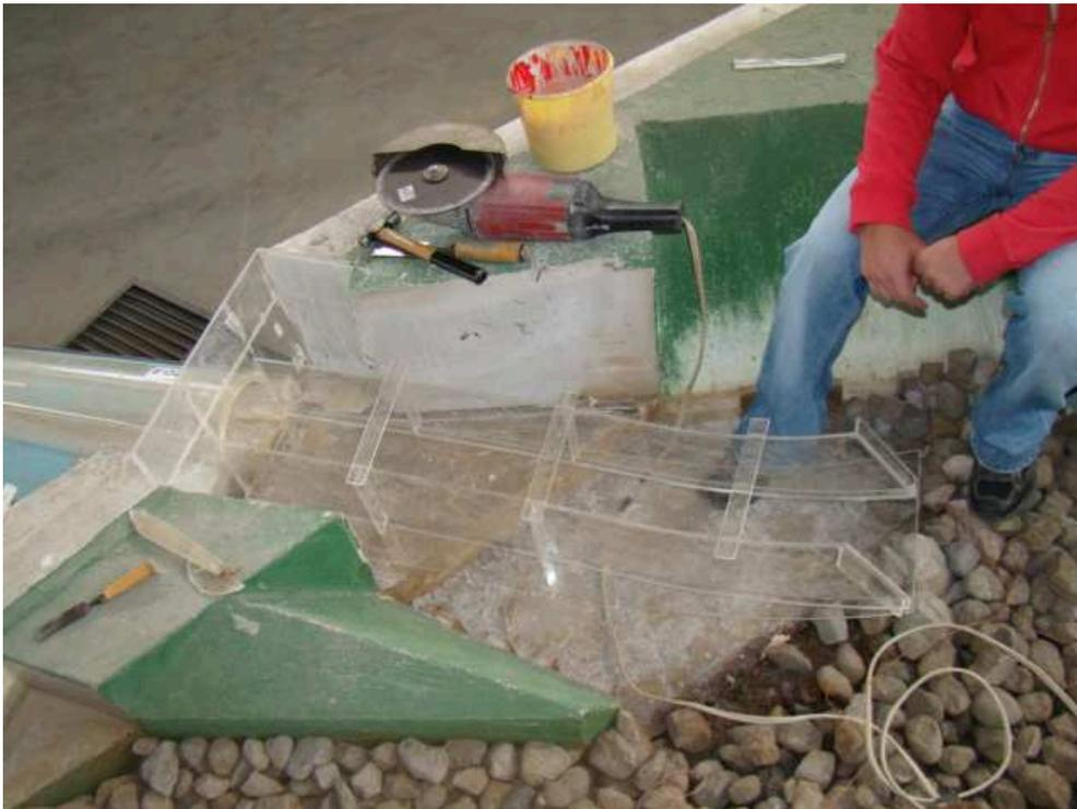
Fotografía No.13.- Vista del esquí a la salida del túnel de desvío. Variante 1.
