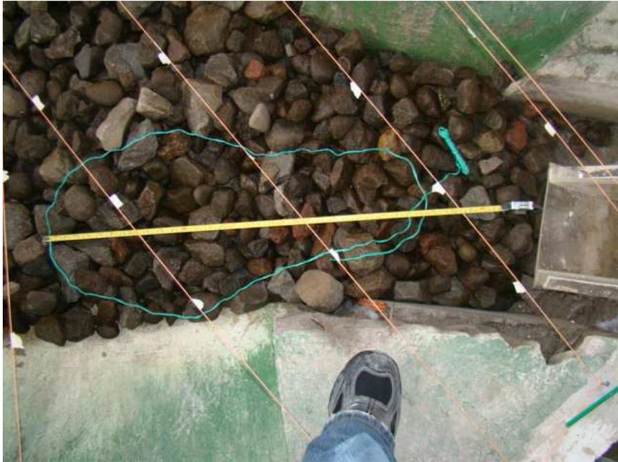
Fotografía No.79.- Cuenco de socavación que definió el cuenco preexcavado producto del funcionamiento del modelo.  $Q=500 \text{ m}^3/\text{s}$  – Variante 4
