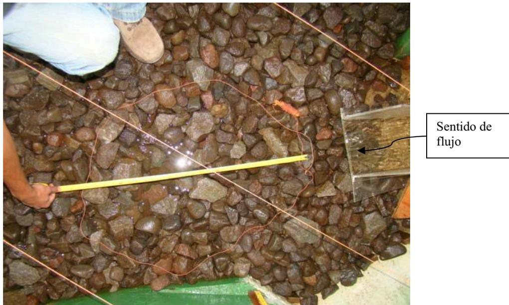
Fotografía No. 47.- Cuenco de socavación producto del caudal  $Q=500\text{m}^3/\text{s}$  – Variante 2.
