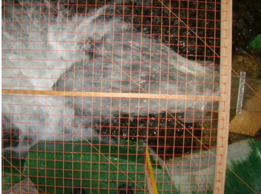
Fotografía No. 31.- Vista aérea del chorro producto del  $Q=1130\text{m}^3/\text{s}$  donde se nota claramente la desigualdad del chorro debido a la influencia de la segunda curvatura en planta – Variante 1.
