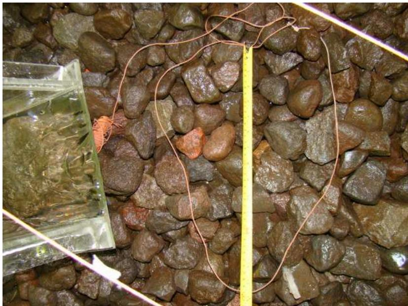
Fotografía No.77.- Cuenco de socavación producto de la alternativa 3.  $Q=200 \text{ m}^3/\text{s}$  – Variante 3.
