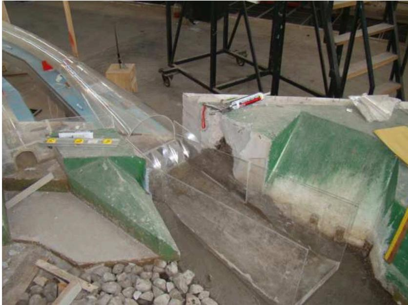
Fotografía No. 11.- Cuenco disipador tipo IV colocado inmediatamente aguas debajo de la transición.
