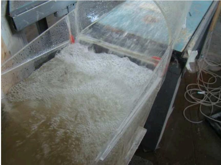
Fotografía No.62.- Vista aérea del funcionamiento del disipador.  $Q=100 \text{ m}^3/\text{s}$  – Variante 2.
