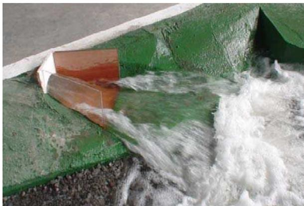
Fotografía No. 3.- Vista superior del funcionamiento de la estructura de salida con  $QTD=951\text{m}^3/\text{s}$ .
