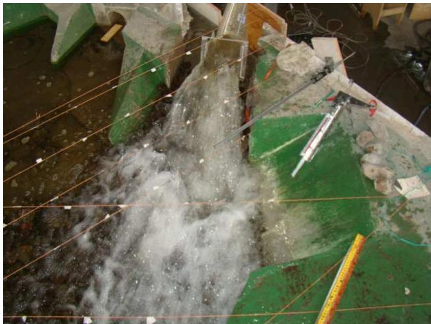
Fotografía No.84.- Funcionamiento del dissipador y comportamiento del cuenco preexcavado para  $Q=800 \text{ m}^3/\text{s}$
