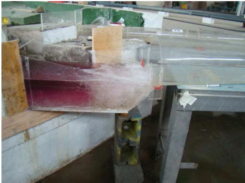
Fotografía No.63.- Vista lateral del escalón negativo del disipador.  $Q=100 \text{ m}^3/\text{s}$  – Variante 2.
