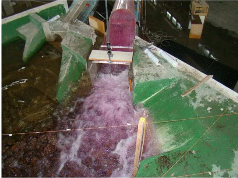
Fotografía No.54.- Vista frontal del funcionamiento de la cubeta modificada.  $Q=1130 \text{ m}^3/\text{s}$  – Variante 2.
