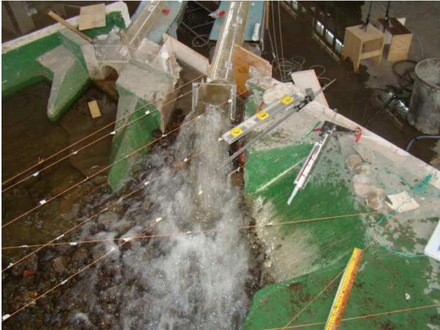
Fotografía No.83.- Funcionamiento del dissipador y comportamiento del cuenco preexcavado para  $Q=500 \text{ m}^3/\text{s}$
