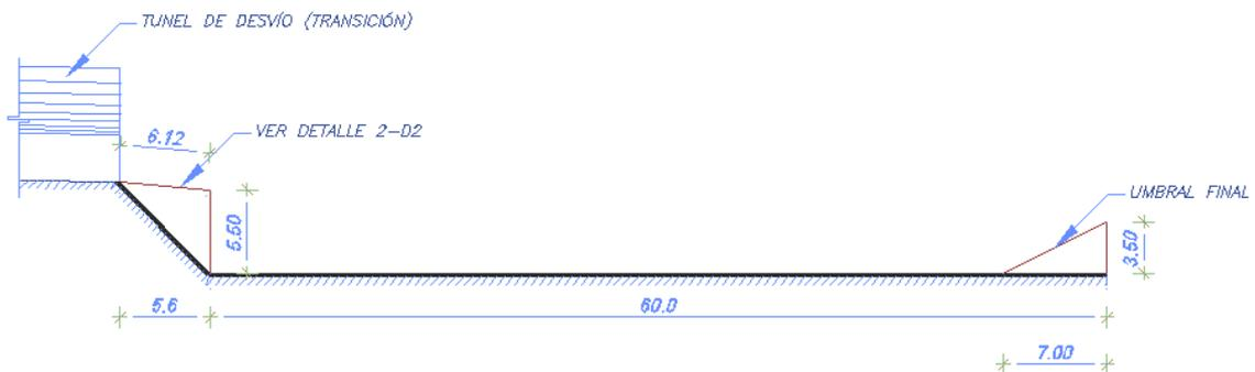
Figura No. 46.- Vista lateral del cuenco disipador tipo IV.
