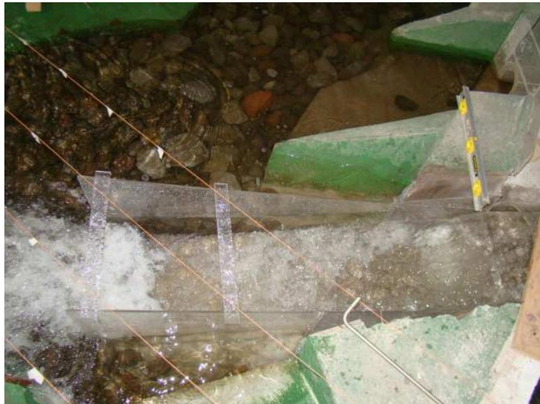
Fotografía No. 29.- Prueba para  $Q=800\text{m}^3/\text{s}$ , puede notarse como la condición del resalto hidráulico es de total desplazamiento.
