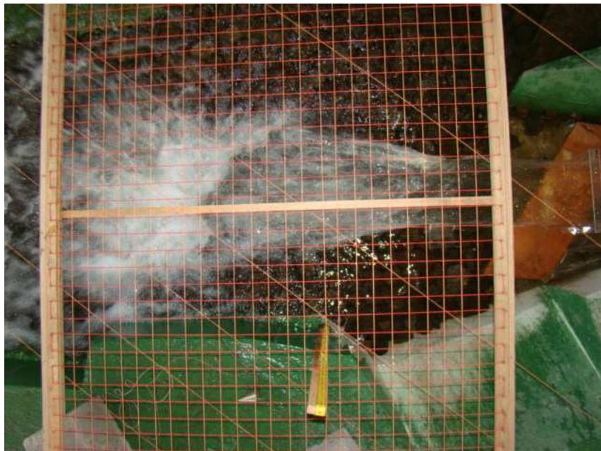
Fotografía No. 38.- Vista aérea del chorro producto de  $Q=800\text{m}^3/\text{s}$  – Variante 2.
