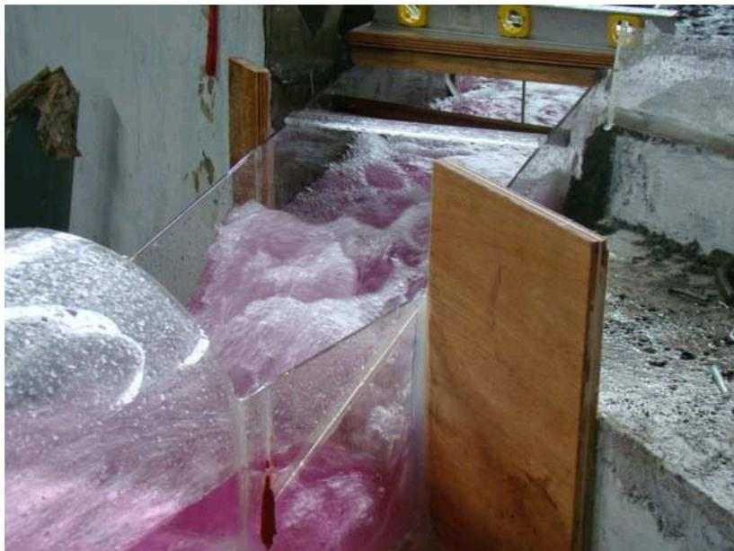
Fotografía No.56.- Vista aérea del funcionamiento del disipador.  $Q=800 \text{ m}^3/\text{s}$  – Variante 2.
