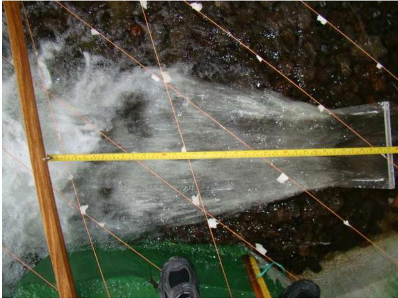
Fotografía No.72.- Vista aérea del funcionamiento de la tercera variación del salto en esquí.  $Q=1130 \text{ m}^3/\text{s}$  – Variante 3.
