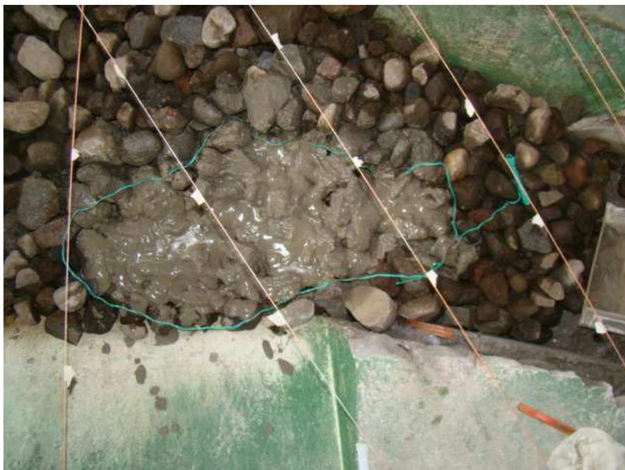
Fotografía No.80.- Cuenco de preexcavado con lechada de cemento.  $Q=500 \text{ m}^3/\text{s}$  – Variante 4
