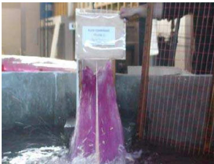
Fotografía No. 1.- Vista frontal del flujo de salida del dissipador de energía tipo Kumin con un caudal de 1.022 m<sup>3</sup>/s.
