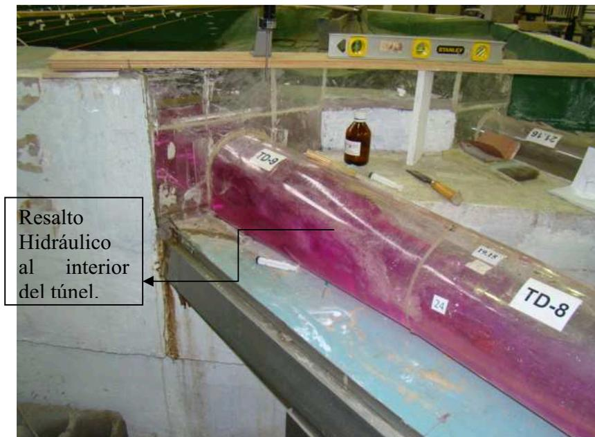
Fotografía No.67.- Vista del resalto hidráulico producido por la altura del esquí.  $Q=200 \text{ m}^3/\text{s}$  – Variante 3.
