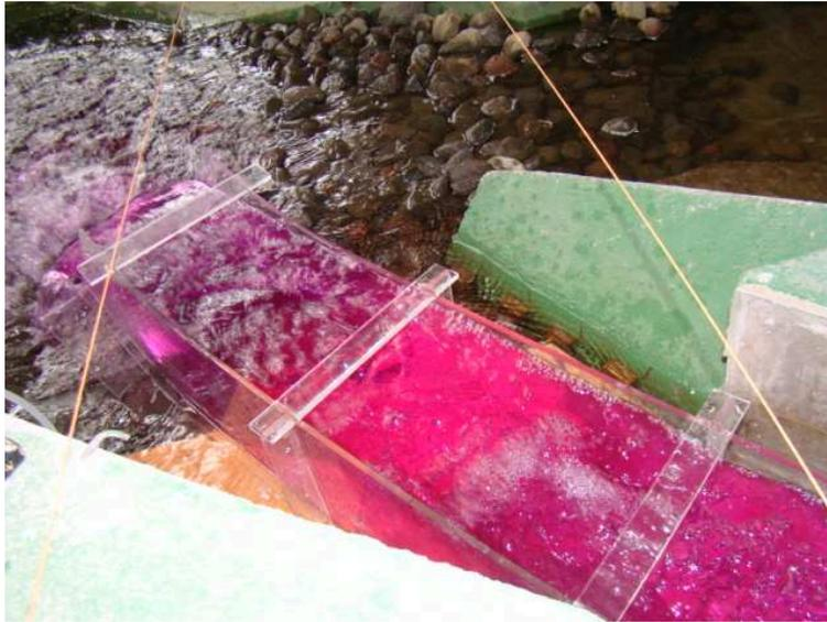
Fotografía No. 41.- Vista aérea del funcionamiento del dissipador producto de caudales inferiores al límite de funcionamiento  $Q=200\text{m}^3/\text{s}$  – Variante 2.
