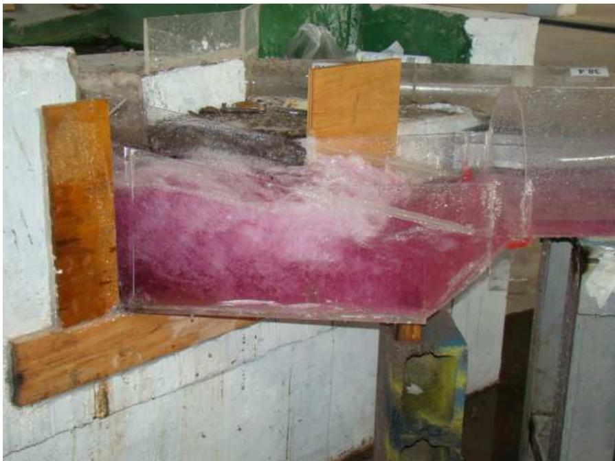
Fotografía No.59.- Vista lateral del escalón negativo del disipador.  $Q=500 \text{ m}^3/\text{s}$  – Variante 2.
