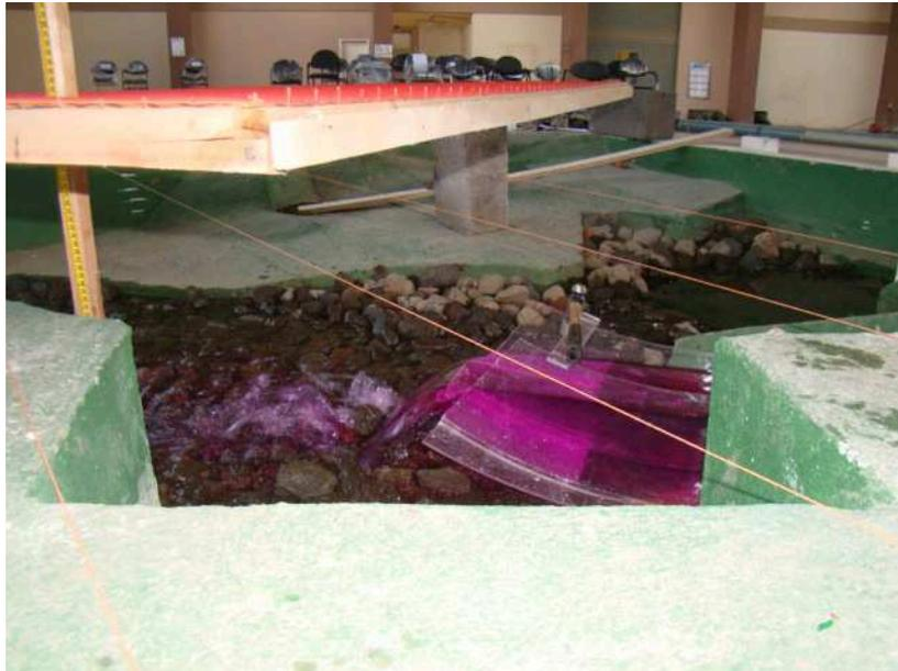
Fotografía No. 43.- Vista lateral del funcionamiento del esquí.  $Q=100\text{m}^3/\text{s}$  – Alternativa 2.
