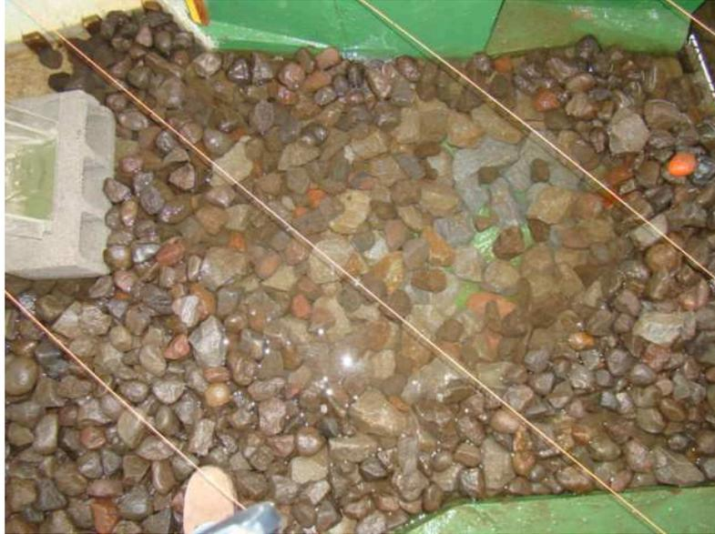
Fotografía No. 33.- Cuenco de socavación producto del  $Q=1130\text{m}^3/\text{s}$  – Variante 1.
