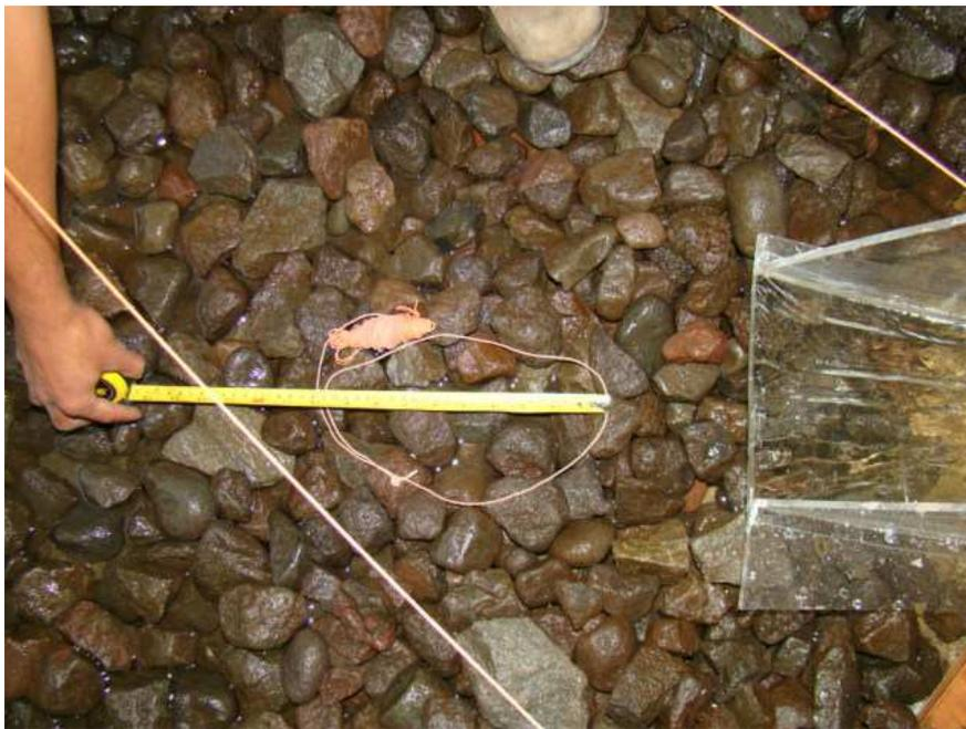
Fotografía No. 50.- Cuenco de socavación producto del caudal  $Q=100\text{m}^3/\text{s}$  – Variante 2.
