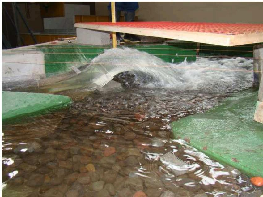
Fotografía No. 32.- Vista lateral del chorro producto del  $Q=1130\text{m}^3/\text{s}$  – Variante 1.
