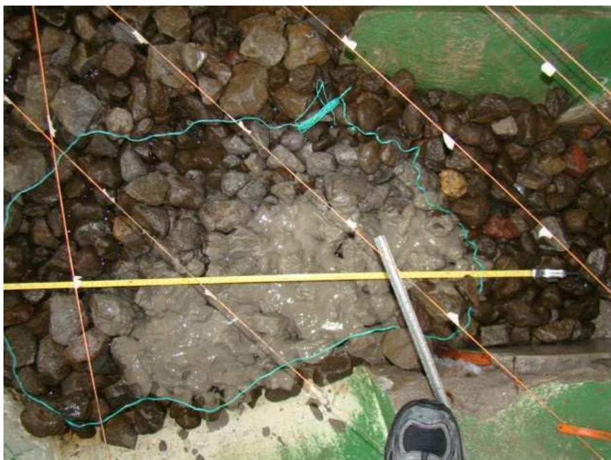
Fotografía No.89.- Cuenco de socavación producto de  $Q=1130 \text{ m}^3/\text{s}$  – Variante 4
