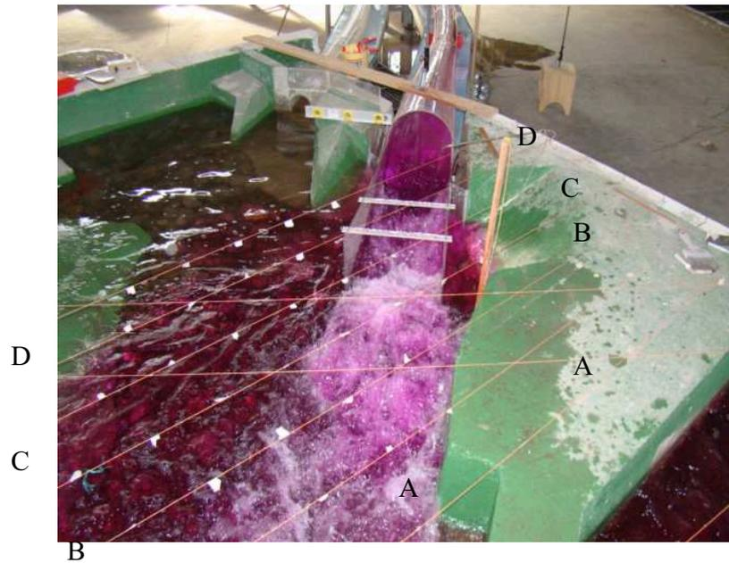
Fotografía No. 21.- Secciones de medición de velocidades y disipación de energía.
