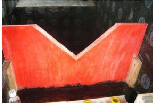
Fotografía No. 18.- Vista frontal de un vertedero triangular de medida.
