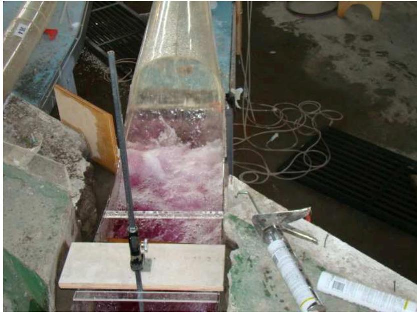
Fotografía No.58.- Vista aérea del funcionamiento del disipador.  $Q=500 \text{ m}^3/\text{s}$  – Variante 2.
