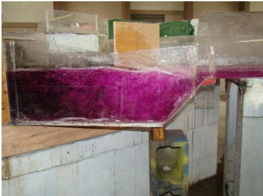
Fotografía No.61.- Vista lateral del escalón negativo del dissipador.  $Q=200 \text{ m}^3/\text{s}$  – Variante 2.
