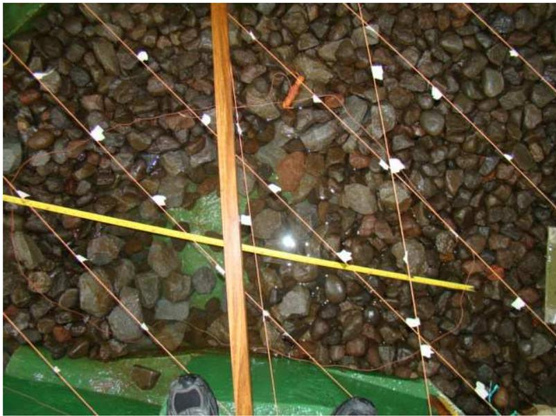
Fotografía No.74.- Cuenco de socavación producto de la alternativa 3.  $Q=1130 \text{ m}^3/\text{s}$  – Variante 3.
