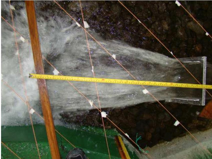
Fotografía No.70.- Vista aérea del funcionamiento de la tercera variación del salto en esquí.  $Q=800 \text{ m}^3/\text{s}$  – Variante 3.
