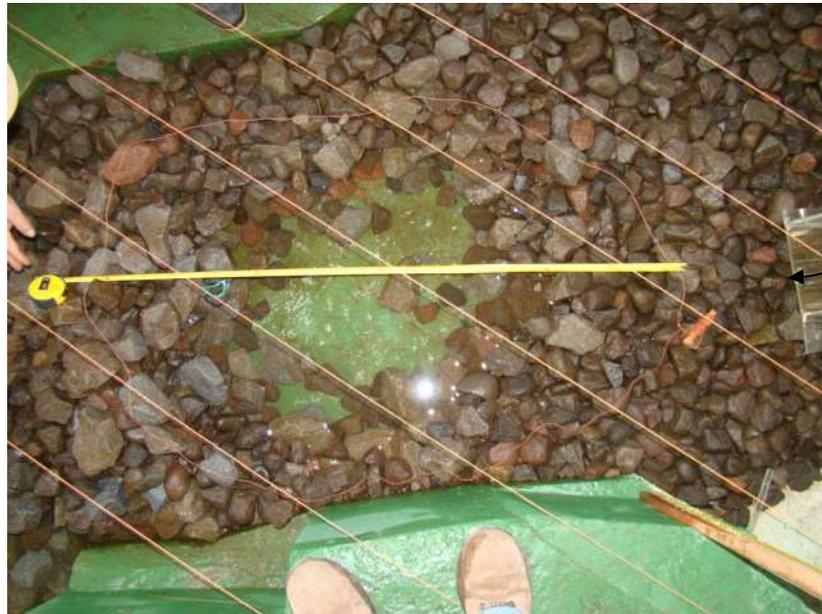
Fotografía No. 45.- Cuenco de socavación producto del caudal  $Q=1130\text{m}^3/\text{s}$  – Variante 2.
