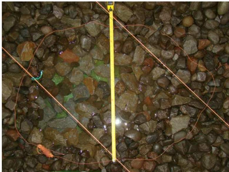
Fotografía No. 35.- Cuenco de socavación producto del caudal de funcionamiento límite  $Q=1000\text{m}^3/\text{s}$  – Variante 1.
