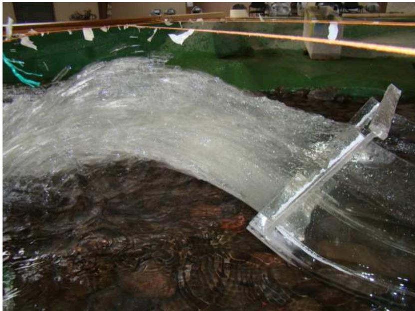
Fotografía No.71.- Vista lateral del funcionamiento de la tercera variación del salto en esquí.  $Q=800 \text{ m}^3/\text{s}$  – Variante 3.
