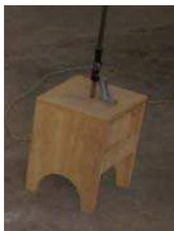
Fotografía No. 14.- Limnómetro móvil empleado en la sección circular del túnel de desvío
