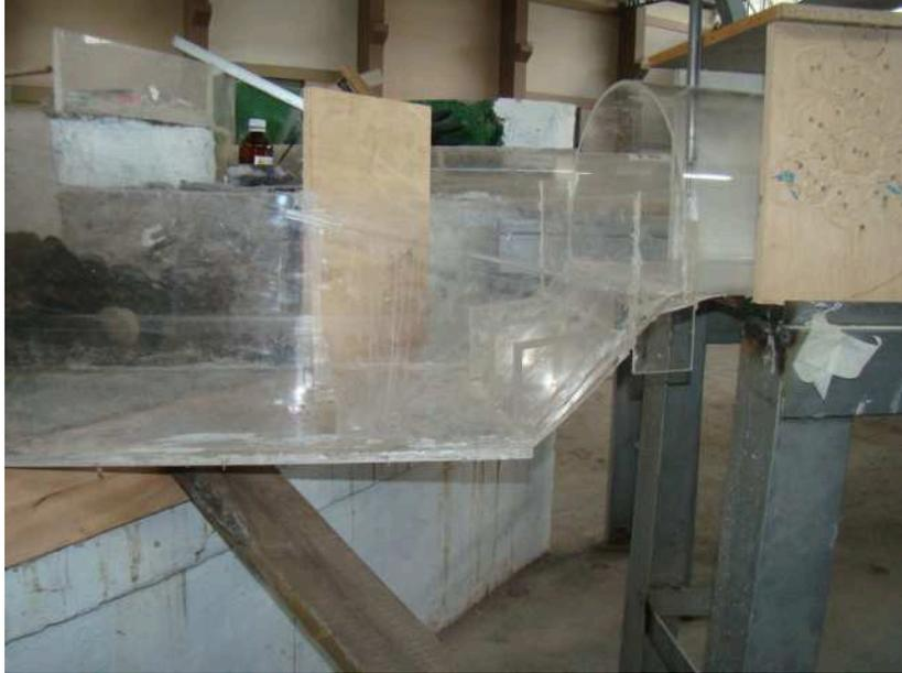
Fotografía No.53.- Vista lateral de la nueva implantación de la cubeta. Vista frontal.
