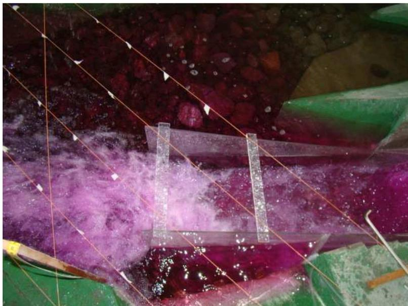
Fotografía No. 30.- Prueba para  $Q=1130\text{m}^3/\text{s}$ , puede notarse como la condición del resalto hidráulico es similar al caudal  $Q=800\text{m}^3/\text{s}$ .
