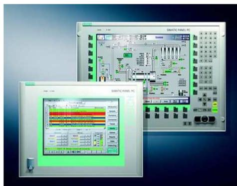
Figura 1.4. Ejemplo de panel HMI
