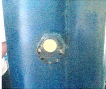
Figura 2.31. Segunda resistencia de calentamiento
