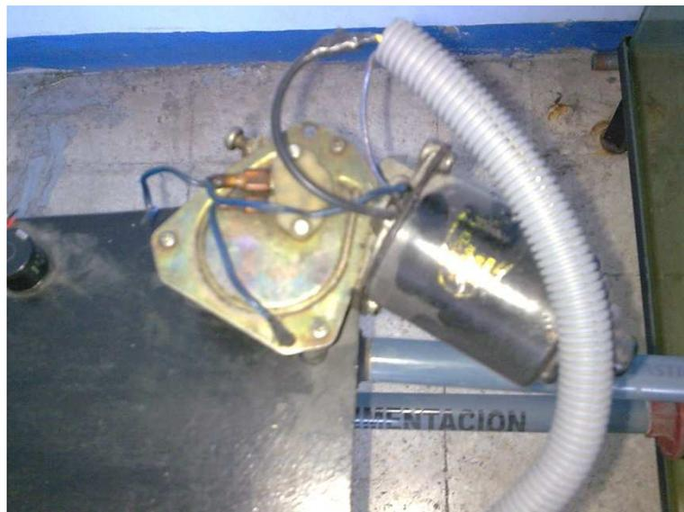
Figura 2.7. Servoválvula construida
