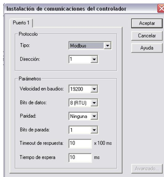
Figura 3.4 Configuración de comunicaciones
