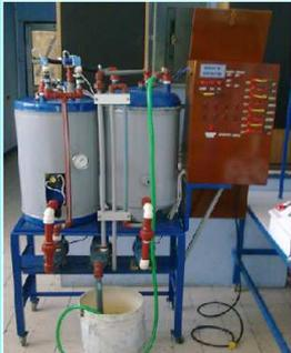
Para el llenado y vaciado del agua del intercambiador, se dispone de dos bombas.
