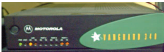
Figura 2.24. Vista frontal ruteador Vanguard 340 [2.9]
