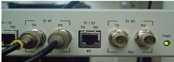
Figura 2.11. Conexión de Tributarios [2.9]
