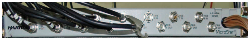
Figura 2.7. Conexión de Tributario [2.9]
