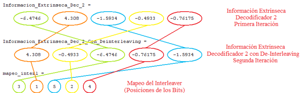
Figura 3.79. Ejecución de Prueba para la Visualización de la Información Extrínseca del Decodificador 2 con De-Interleaving para la Segunda Iteración y Tasa de 1/3.
