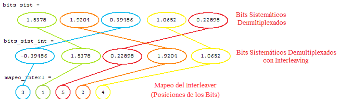
Figura 3.53. Ejecución de Prueba para la Visualización del Interleaving de los Bits Sistemáticos Demultiplexados con Tasa 1/3.
