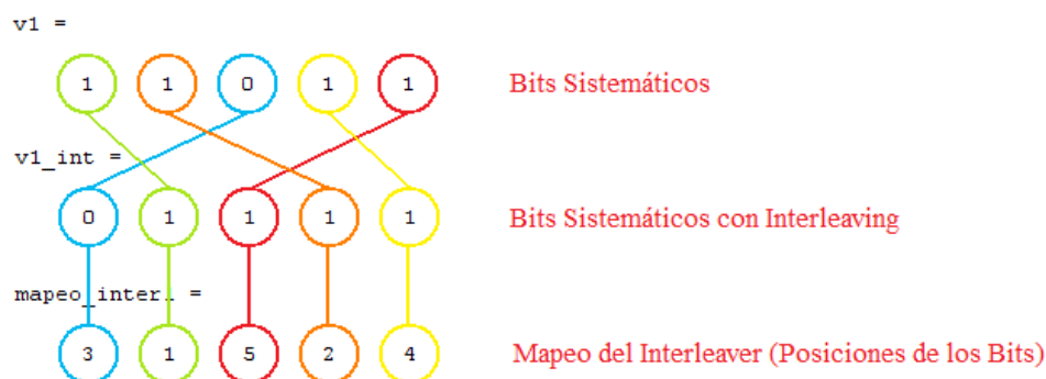
Figura 3.27. Ejecución de Prueba para la Visualización de los Bits Sistemáticos con Interleaving.
