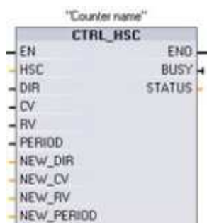
Figura 5-17: Bloque CTRL_HSC contador rápido. Fuente Propia.
