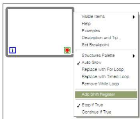
Figura 6-25: Registro de desplazamiento. Fuente Propia.
