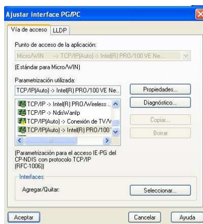
Figura 5-35: Ajustar interface PG/PC. Fuente Propia.
