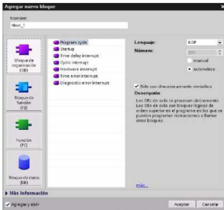
Figura 5-9: Instrucciones para agregar un nuevo bloque. Fuente Propia.
