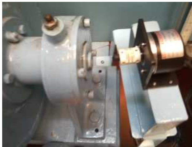
Figura Anexo 3: Calibración del encoder con el eje del motor eléctrico. Fuente Propia.
