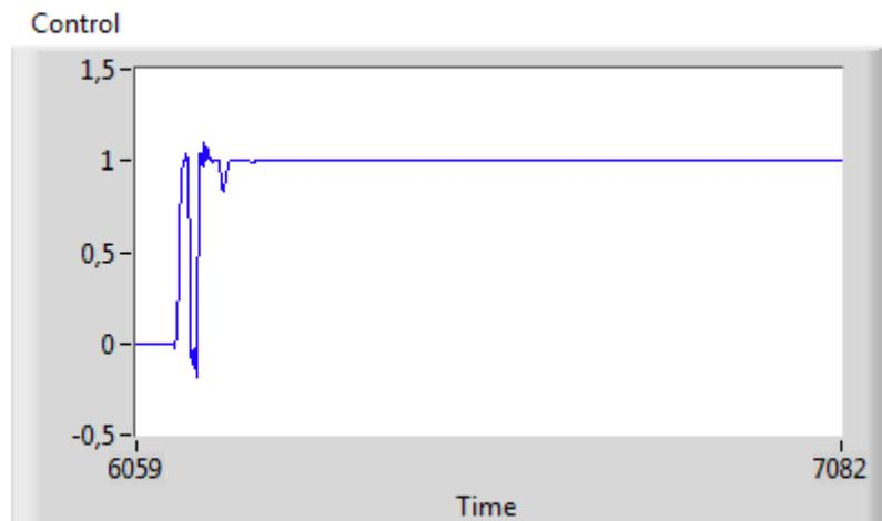
Figura 4.5 Señal de control,  $u[k]$ , para  $T_s = 150\mu s$
