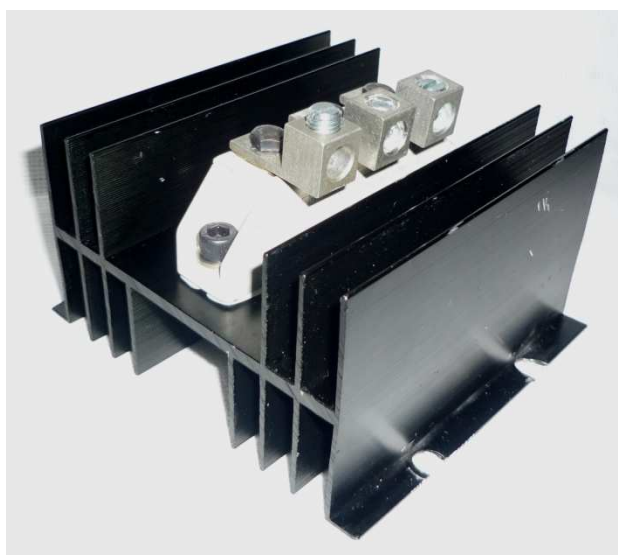
Figura 2.5 Módulo marca SEMIKRON instalado en la soldadora.
