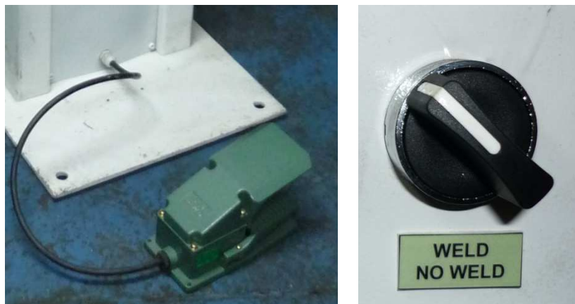
Figura 2.22 Switch de pedal y switch weld instalado en la soldadora
