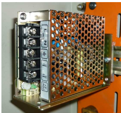
Figura 2.12 Fuente de alimentación de 24VDC / 1A instalada en la soldadora
