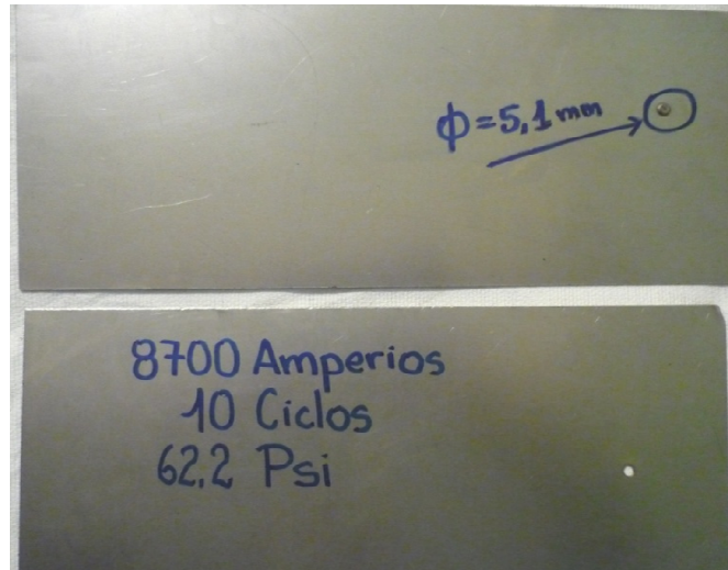
Figura 4.7 Medición de la pepita de soldadura con material 1,0mm.
