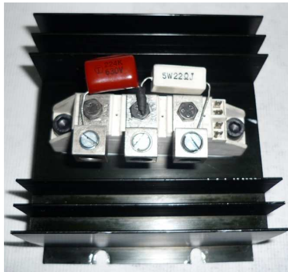
Figura 2.9 Red snubber instalada en el módulo de SCR's.
