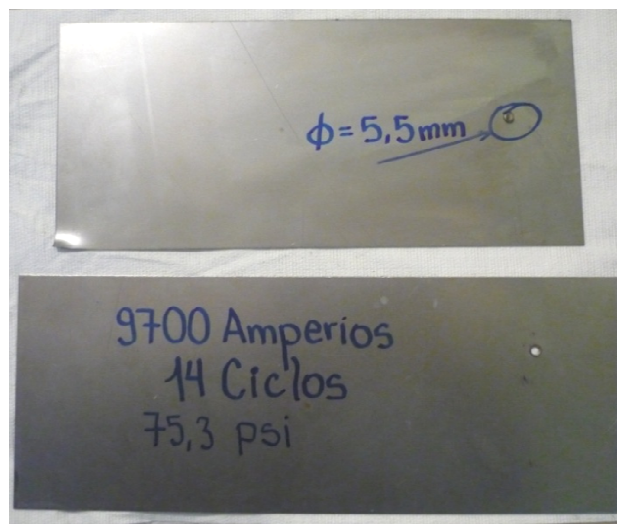
Figura 4.8 Medición de la pepita de soldadura con material 1,2mm.
