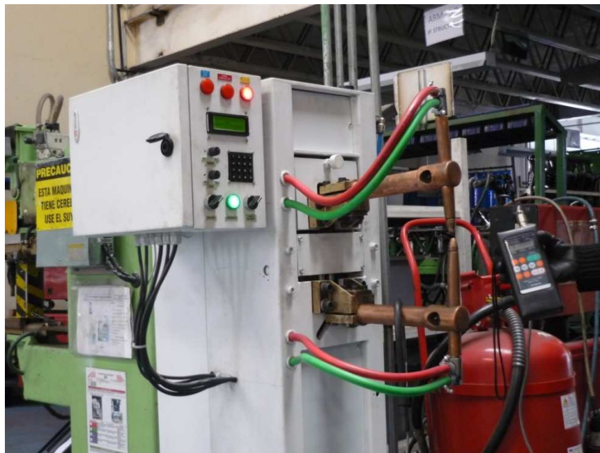
Figura 4.2 Medición de corriente y ciclos con el equipo Miyachi MM – 315A
