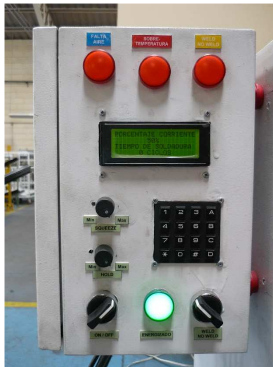
Figura 4.9 Configuración para probar el switch weld / no weld, tiempo de squeeze y hold.
