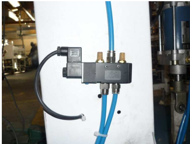
Figura 2.32 Electroválvula de 5 vías – 2 posiciones.
