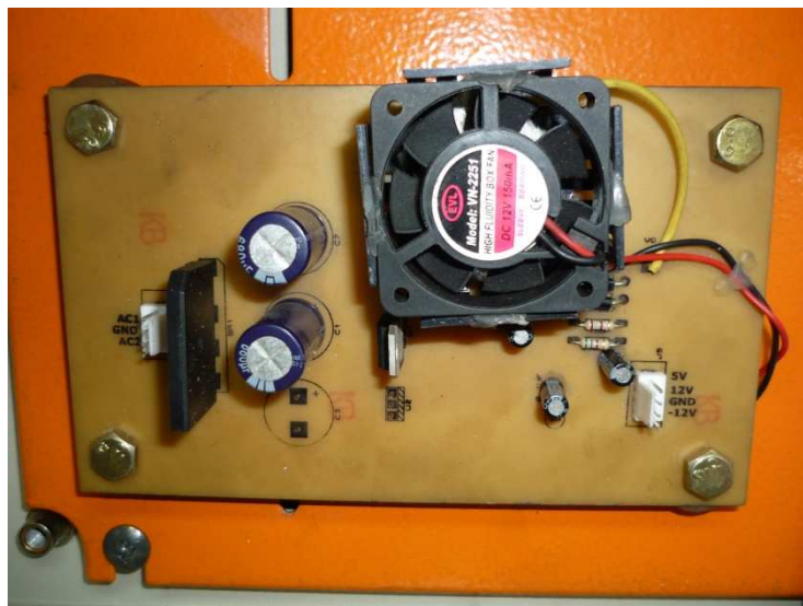
Figura 2.11 Fuente de alimentación de 5 VDC / 2A instalada en la soldadora.
