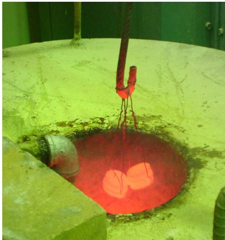
**Figura 62.** Probetas listas para enfriarse
