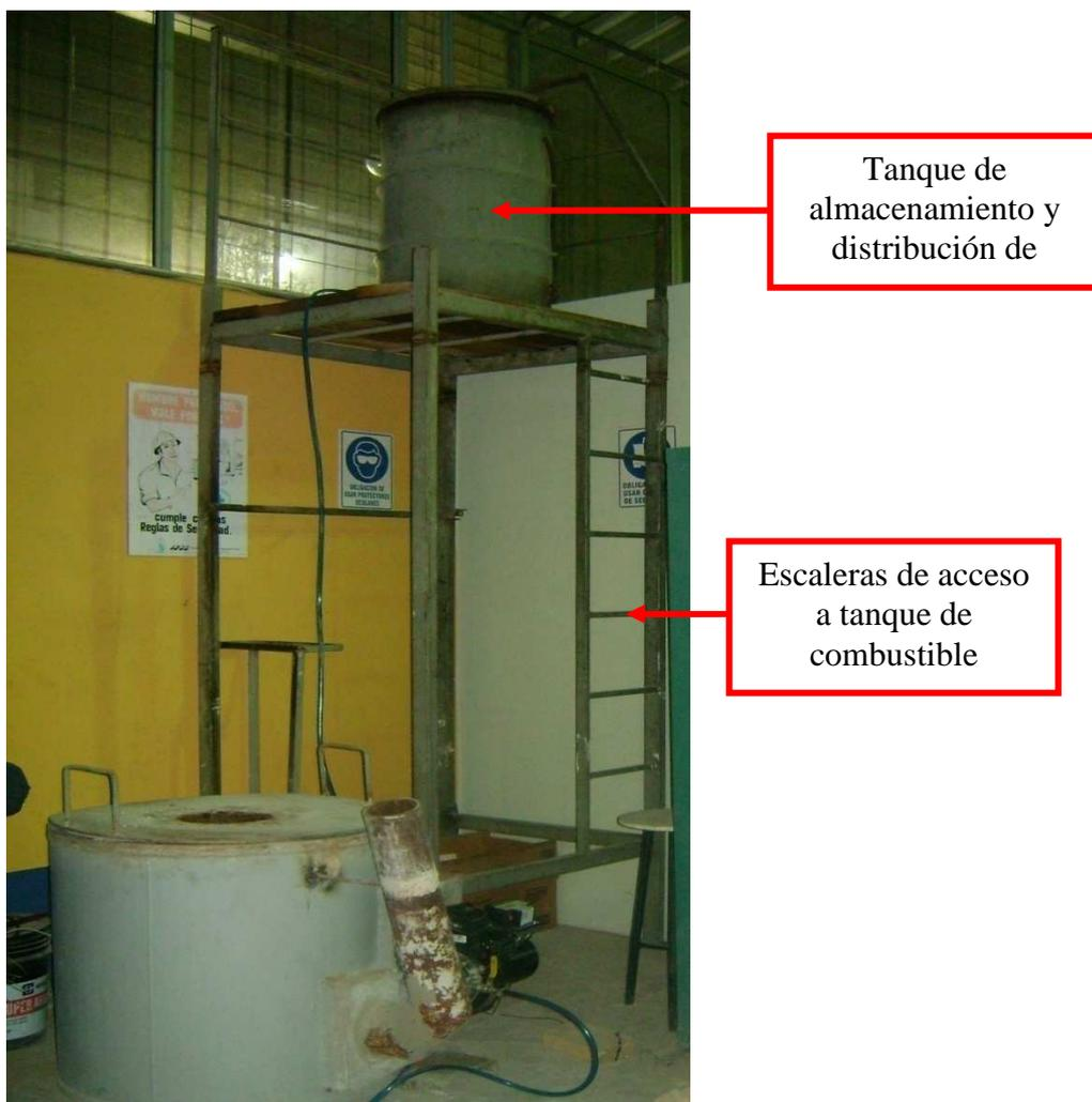
**Figura 68.** Tanque de almacenamiento diesel.
