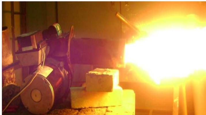
**Figura 56.** Pruebas de quemador en vacío fuera del horno.
