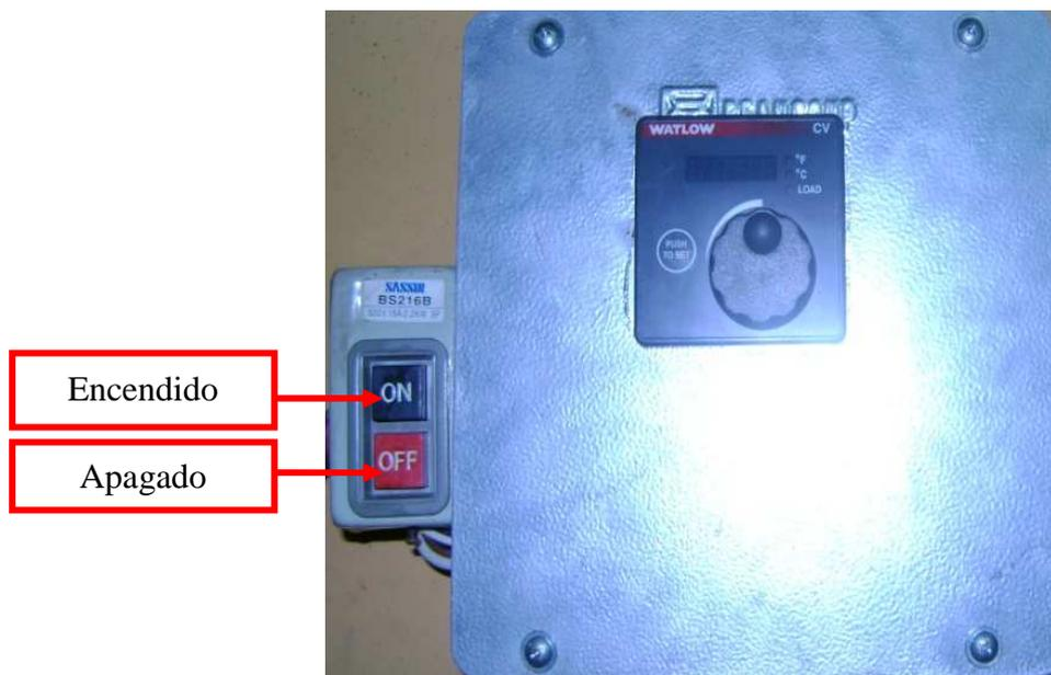
**Figura 72.** Botonera de encendido y apagado del sistema.
