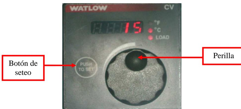
**Figura 74.** Perilla y botón de seteo para temperatura a alcanzar.
