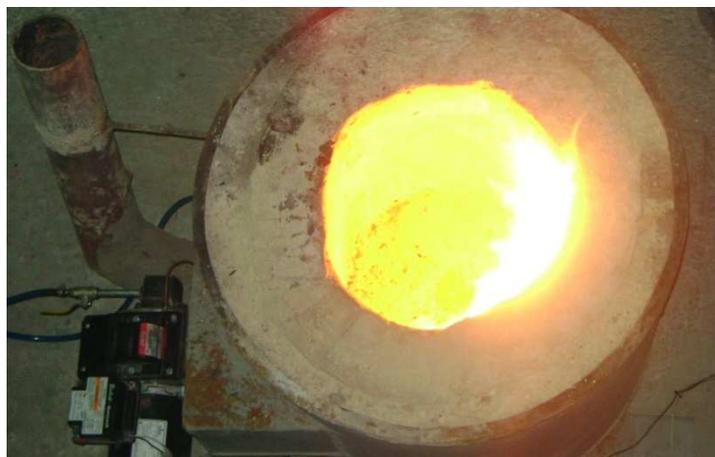
**Figura 57.** Pruebas de quemador en vacío instalado en el horno.
