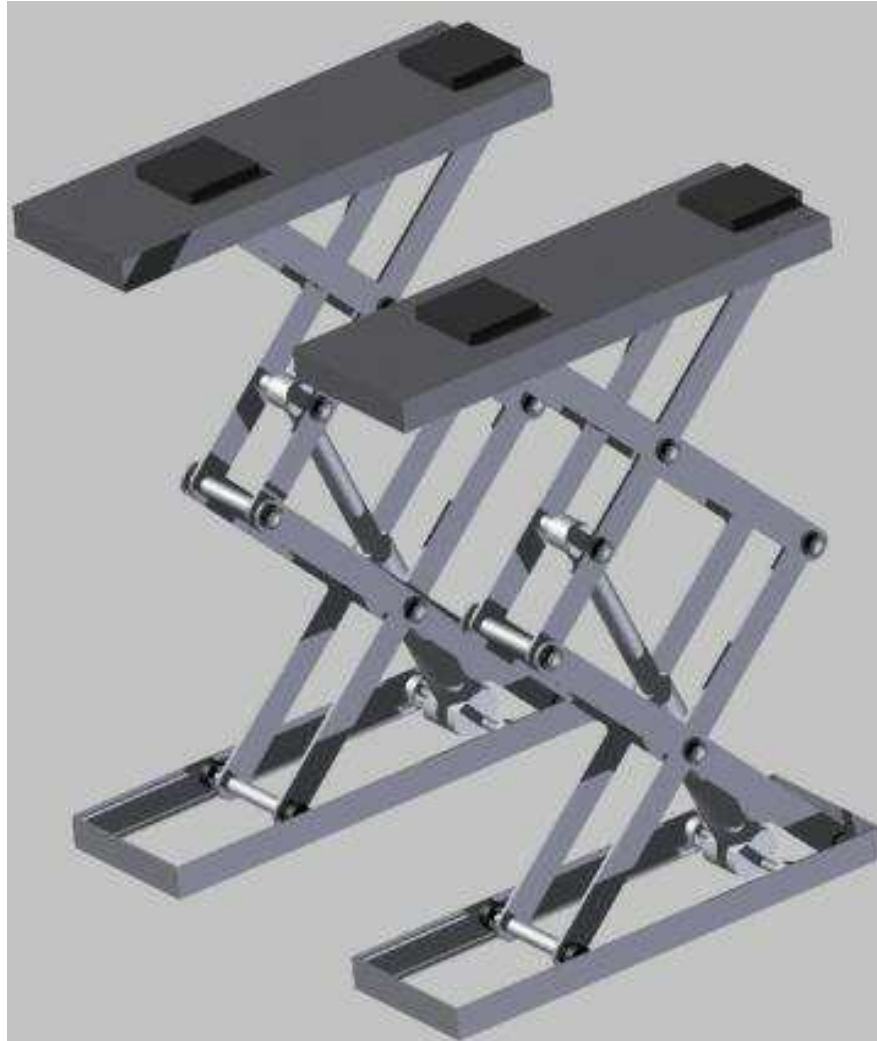
Figura 16. Esquema del Elevador
