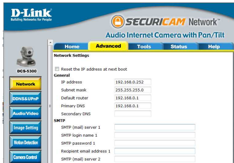
Figura 3. 3 Configuración de red y Acceso Web de la Cámara IP DCS-5300
