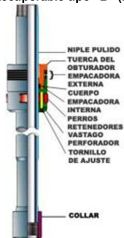
Figura 1.7 Obturador Recuperable tipo "B" (RPOB) con niple pulido.
