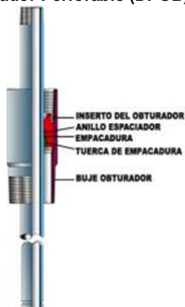
Figura 1.8. Obturador Perforable (DPOB) con niple pulido.
