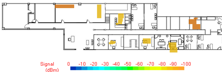
Figura 3.32 Nivel de señal en las oficinas de la Dirección Técnica de Laminados.
