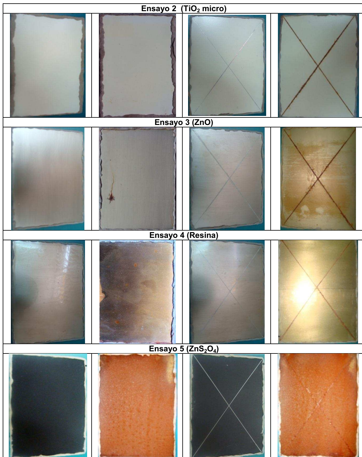
Figura 3.42. Continuación. Fotografías Comparativas entre los blancos y las placas expuestas al ensayo Prohesion durante 600 horas
