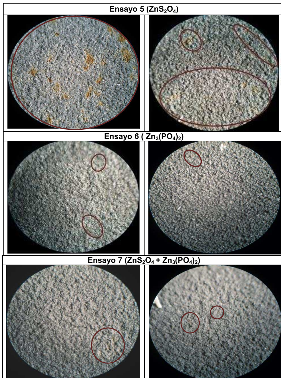
Figura 3.34. Continuación. Fotografías microscópicas de las fallas en los sistemas de pintura estación Pinturas Córdor
