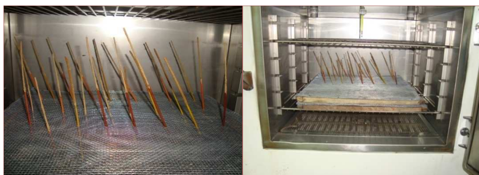
Figura 28. Etapa de secado de los aromatizantes
