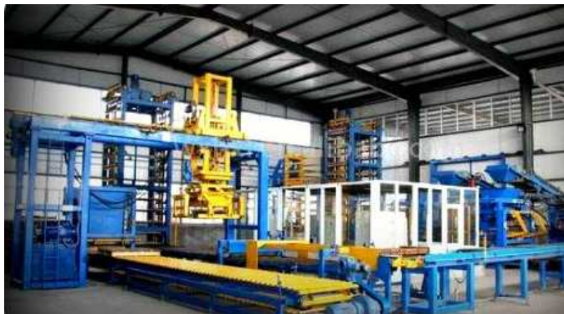
Fotografía 2.3. Central de producción de prefabricados de concreto.
