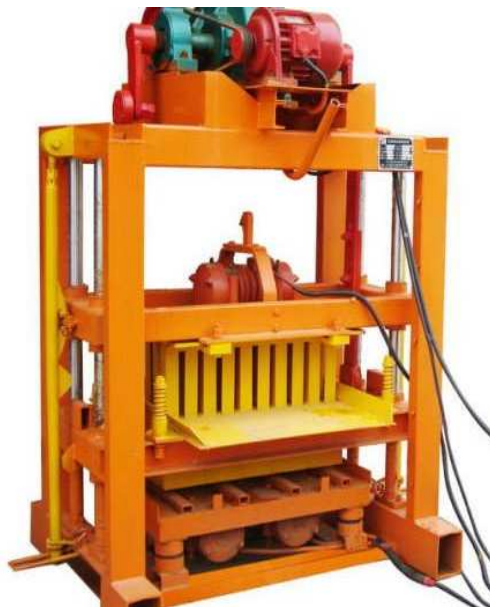
Fotografía 2.6. Máquina semiautomática de prefabricados de concreto.
