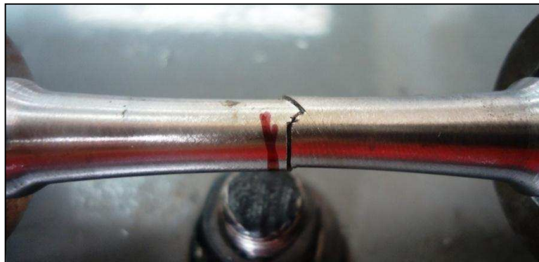
Fotografía 3.3.- Falla en probeta por ensayo de Fatiga
