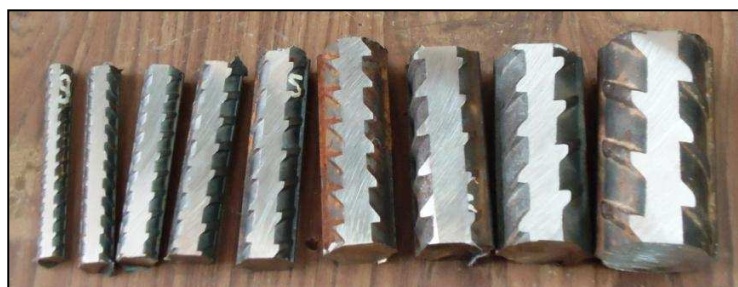
Fotografía 2.5.-Probetas transversales para el ensayo de dureza
