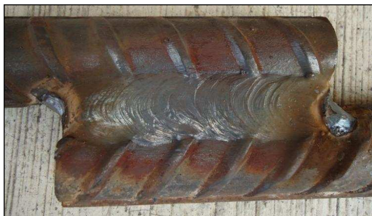
Fotografía 3.6.- Soldadura de las varillas a traslape antes del ensayo a tracción
