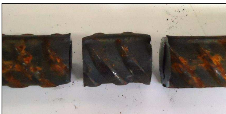
Fotografía 3.5.- Corte doble en varilla de diámetro 14 m
