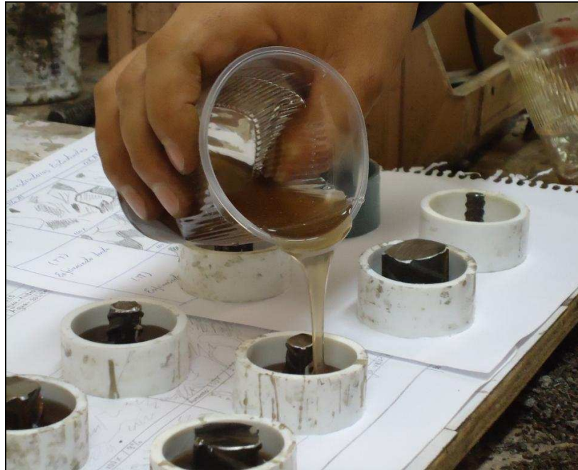
Fotografía 2.20.- Colocación de resina en la probetas
