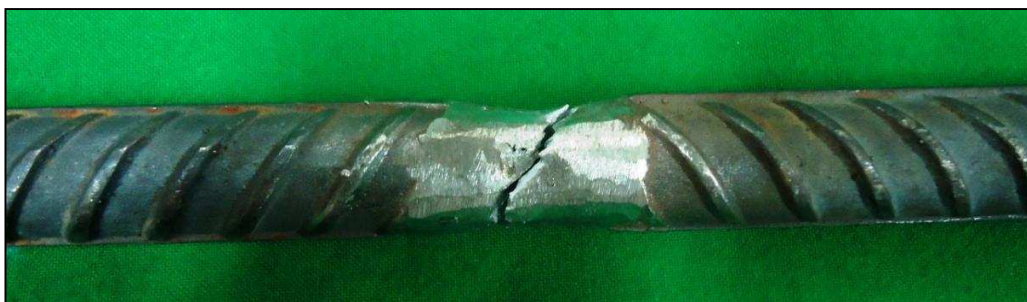
Fotografía 3.12.- Varilla soldada a tope después del ensayo de tracción
