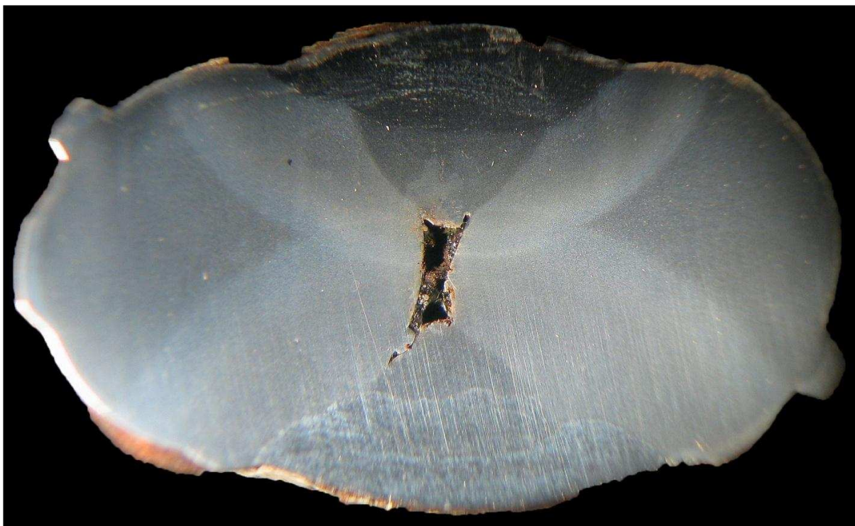
Fotografía 3.10.- Muestra 2 (1G – SMAW): Se observan dos cordones de soldadura los cuales no presentan fusión completa con el metal base ni penetración en la raíz. No se observan poros ni fisuras.
