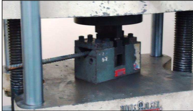
Fotografía 2.13.- Aplicación del esfuerzo cortante en varilla
