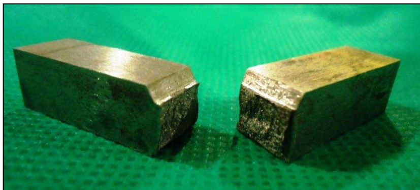
Fotografía 3.13.- Falla de la probeta por carga de impacto
