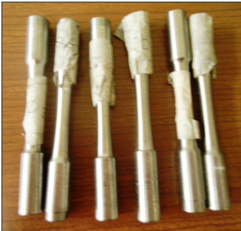
Fotografía 2.8.-Probetas maquinadas para el ensayo de Fatiga
