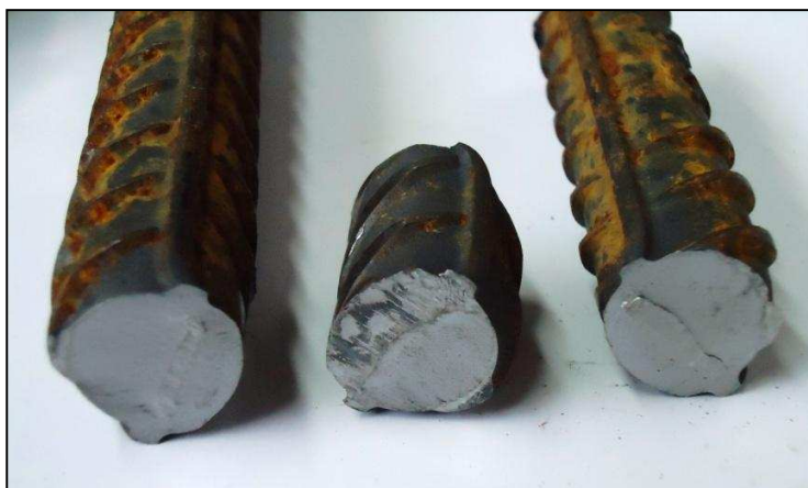
Fotografía 3.4.- Corte doble en varilla de diámetro 14 mm
