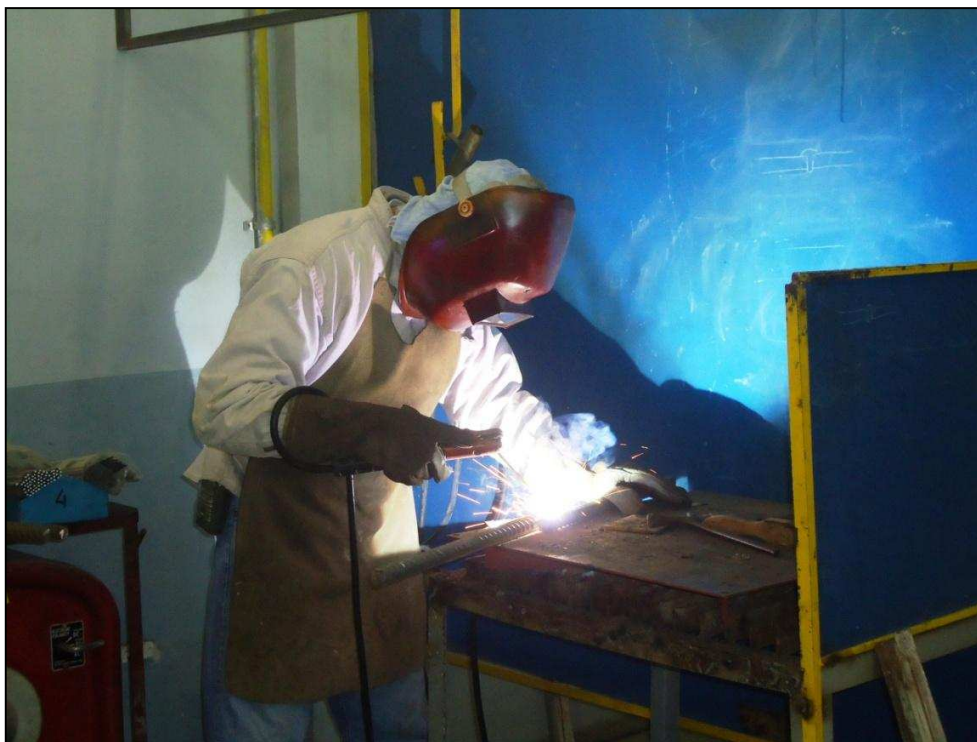
Fotografía 2.14.- Operador soldando en posición 1G.
