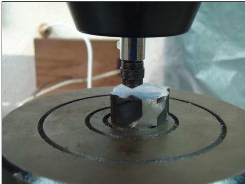
Fotografía 2.7.-Descripción visual del ensayo de dureza
