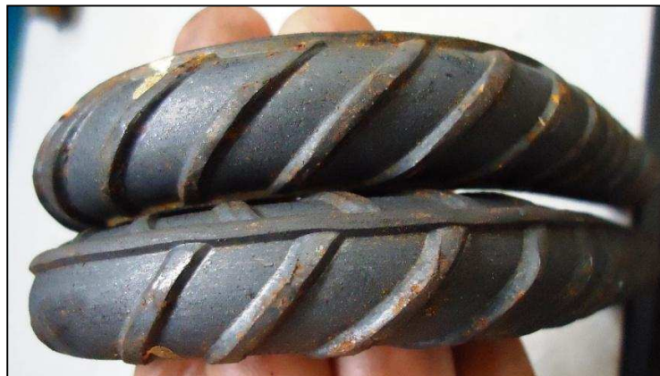
Fotografía 3.2.- Cara externa de las varillas sin fisuración
