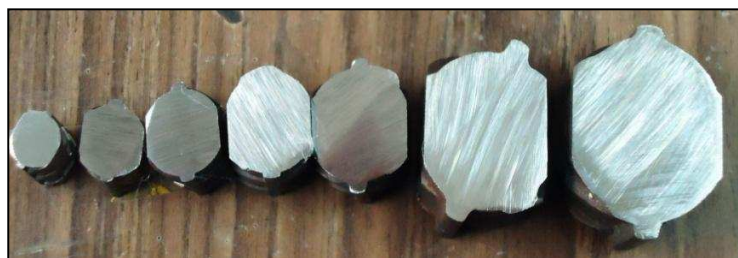
Fotografía 2.6.-Probetas longitudinales para el ensayo de dureza
