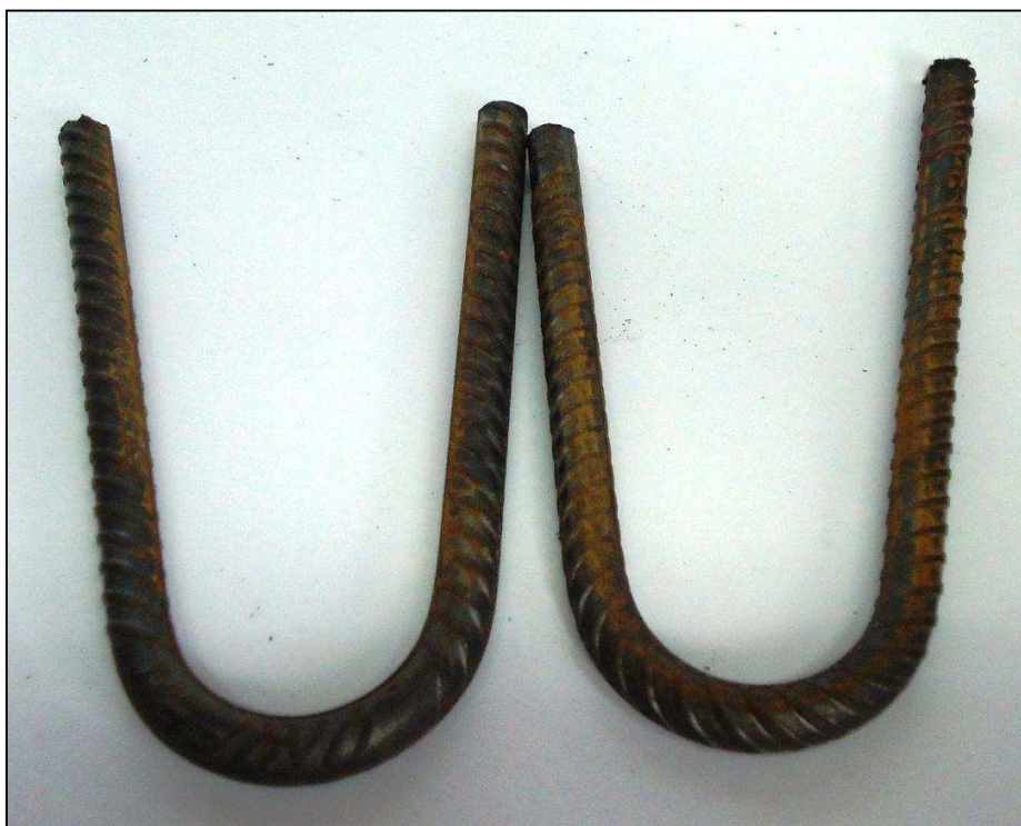
Fotografía 3.1.- Doblado de la varilla a 180°
