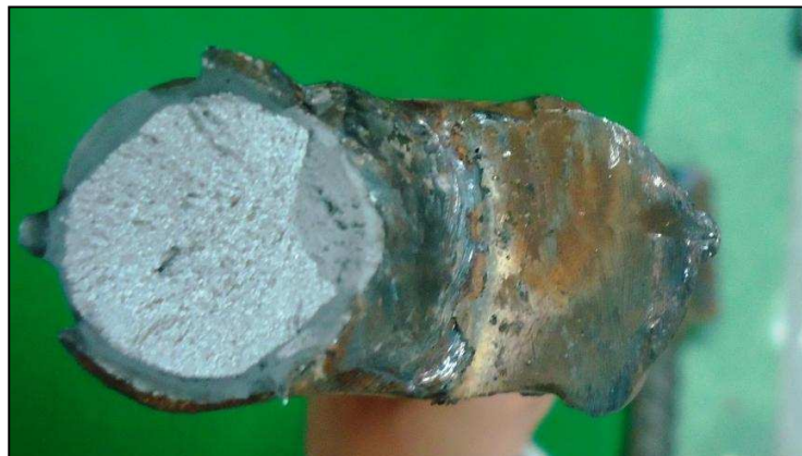
Fotografía 3.11.- Varilla soldada a traslape después del ensayo de tracción
