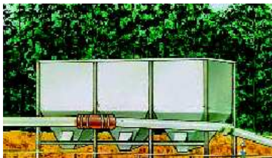
Fig. # 1.33 Depósitos para Aditivos Secos a Granel
