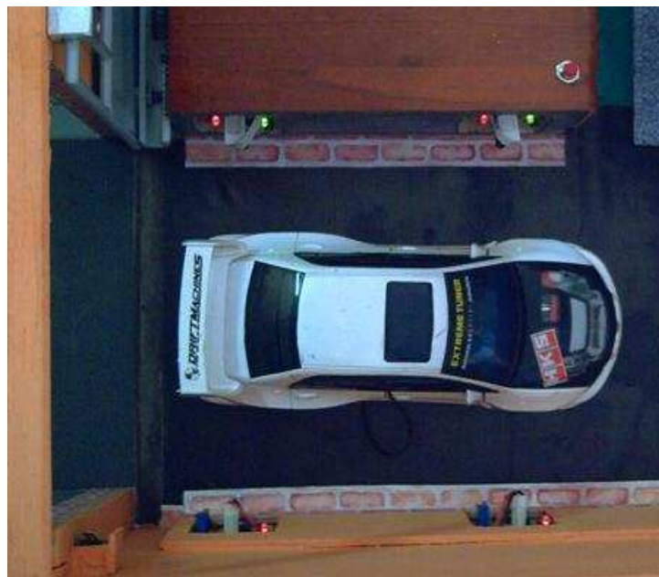
Figura 3.6 Automóvil entre los sensores infrarrojos
