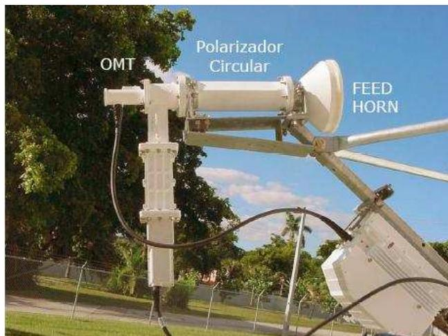
*Fig. 2.8. Elementos Polarización Circular<sup>9</sup>*
