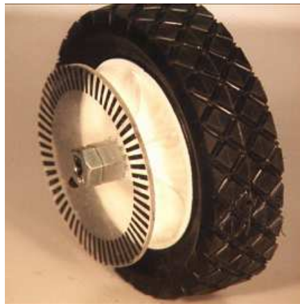
Figura A3 Encoder u odómetro incremental
