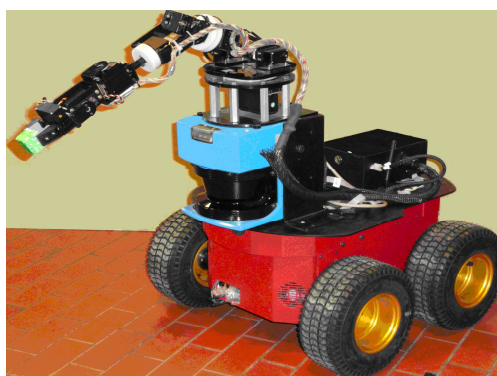
Figura 1.4 Manipulador móvil: robot móvil + brazo robótico.
