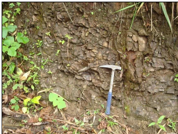
Foto 4.13 Plano de la falla Nanegalito, roca muy fracturada (UTM: 770678E, 20569N).
