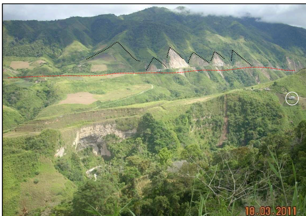
Foto 4.6 Facetas Triangulares por erosión del Batolito Apuela Nanegal en líneas negras. La traza de la falla Apuela dextral en línea roja de dirección Noreste (UTM: 769103E, 18934N, desvío hacia Meridiano). Vea una casa en círculo para escala.
