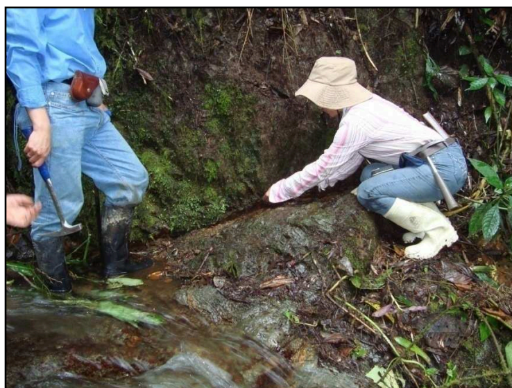
Foto 4.12. Levantamiento realizado en la quebrada Bellavista. Se evidencia el plano de la falla Nanegalito a la entrada de la finca Canaima, esta falla afectarán al túnel de manera puntual (UTM: 770311E, 20287N).
