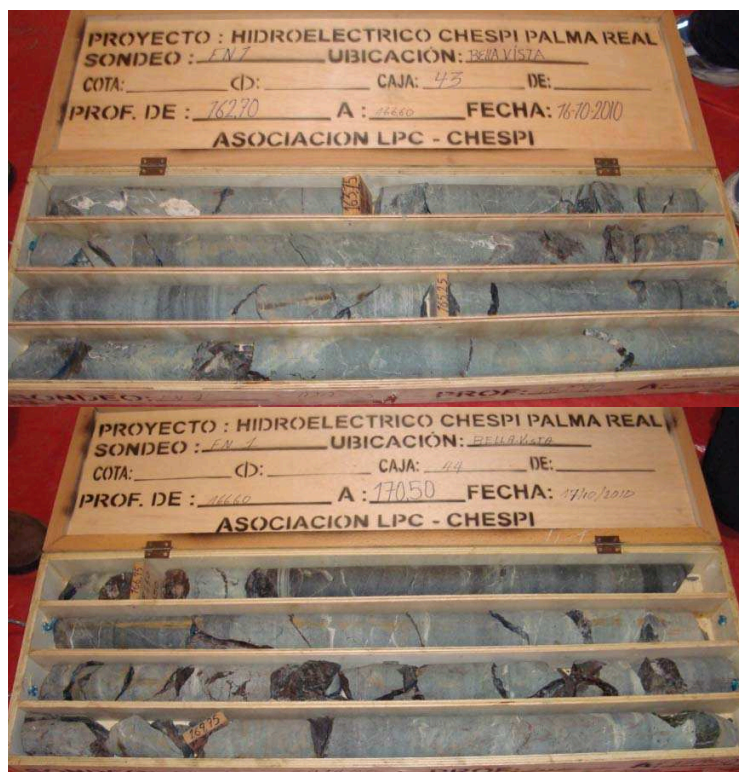
Foto 4.1 Núcleos recuperados del sondeo FN-1. Se observa que en el tramo equivalente a la profundidad del túnel (1320,00), en general se recuperó roca de buena a muy buena calidad.
