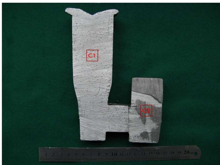
Figura 4.11 Identificación de las muestras en la sección transversal del sistema mazarota-cilindro.
