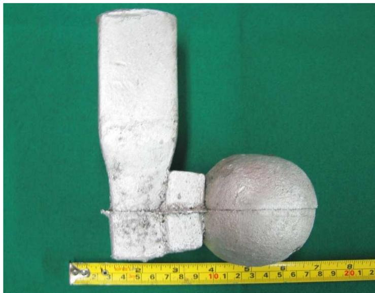
Figura 4.10 Esfera obtenida de la fundición
