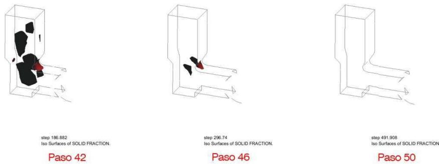
Figura 3.88 Resultados de Fracción Sólida para la esfera hueca. Modelo 2
