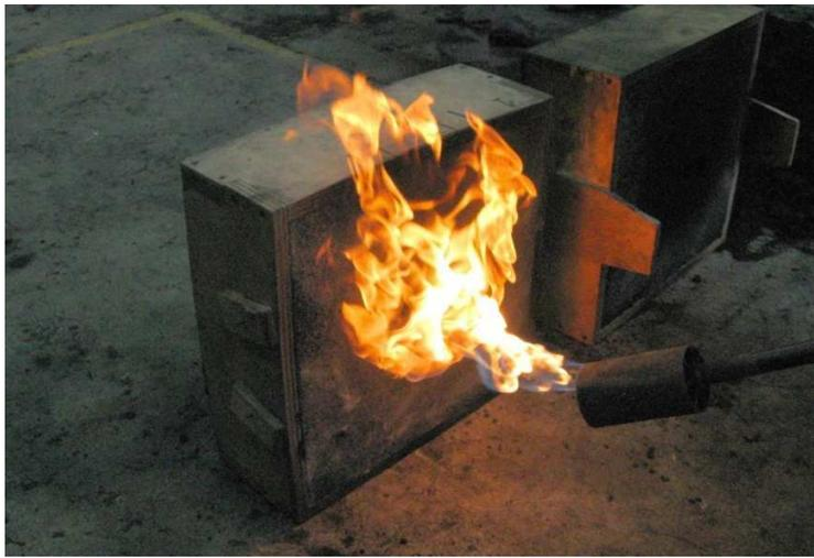
Figura 4.3 Eliminación de humedad del molde
