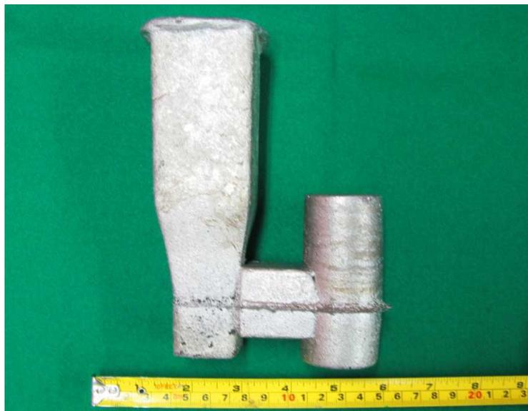
Figura 4.8 Cilindro obtenido de la fundición
