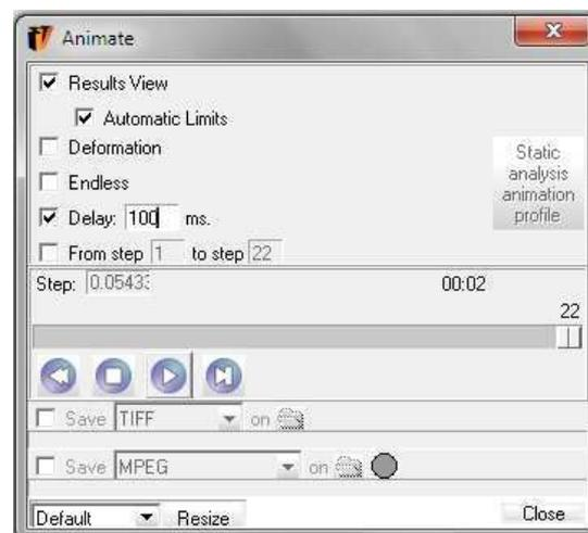
Figura 3.40 Configuración de animación para la evolución de temperaturas.
