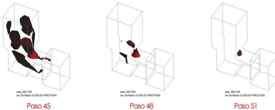
Figura 3.73 Resultados de la Fracción Sólida para el prisma.
