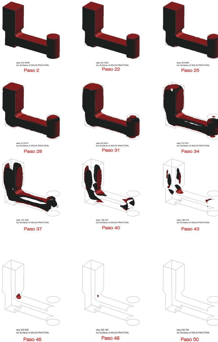
Figura 3.56 Resultados de *Fracción Sólida*. Modelo 1
