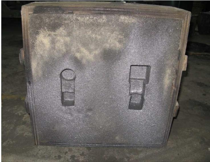
Figura 4.5 Molde inferior para el prisma y l cilindro
