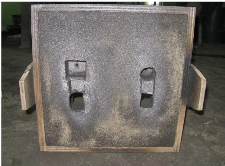
Figura 4.4 Molde superior para el prisma y el cilindro
