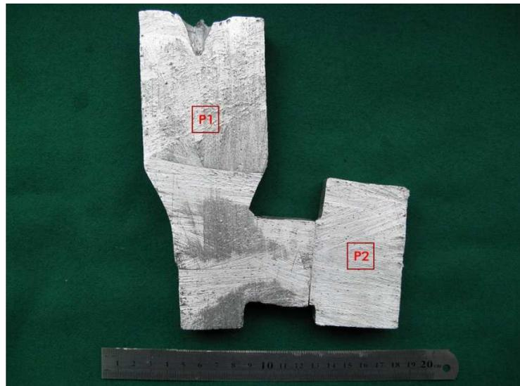
Figura 4.15 Identificación de la muestras en la sección transversal del sistema mazarota-prisma.
