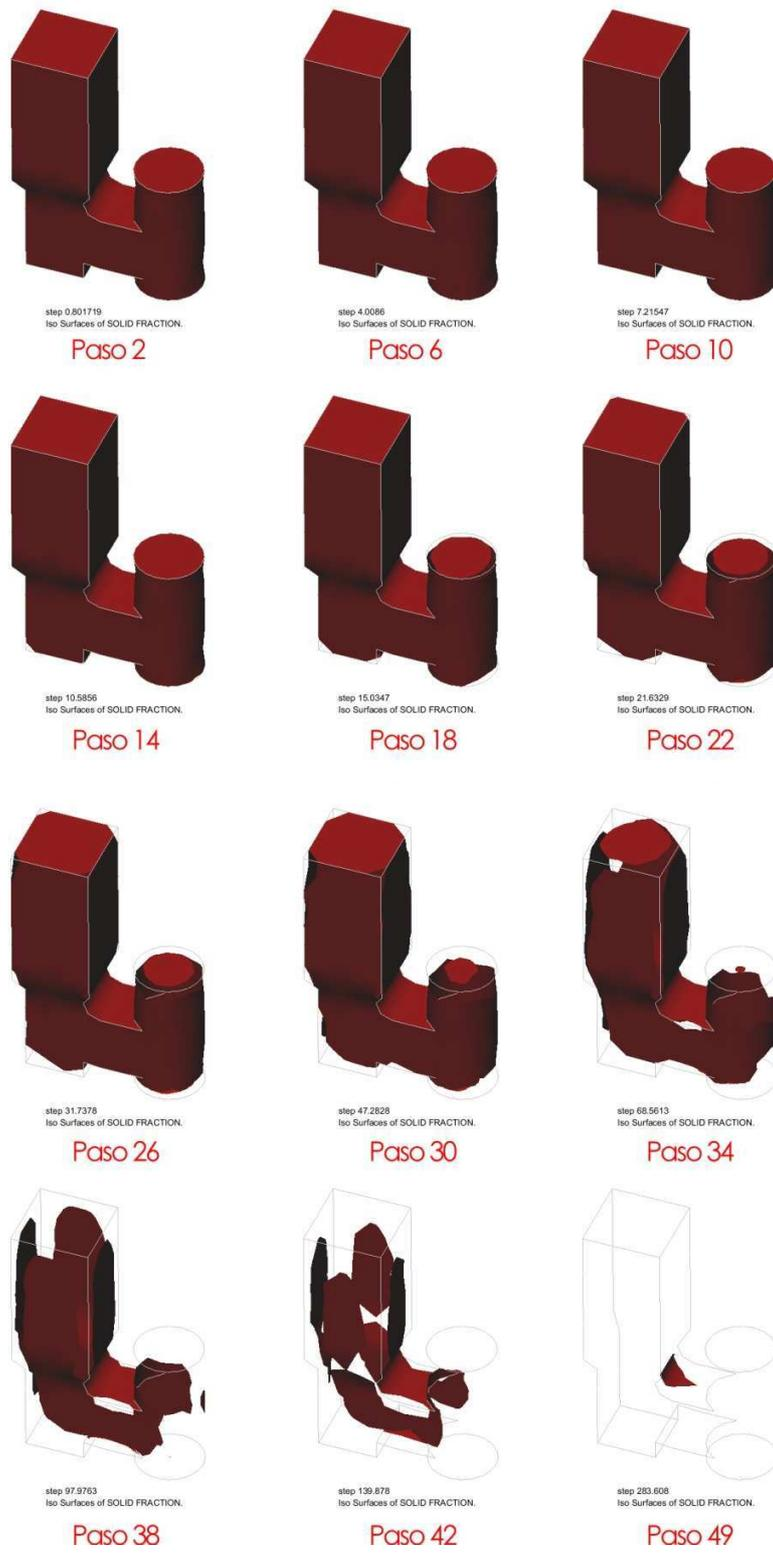
Figura 3.57 Resultados de fracción sólida. Modelo 2
