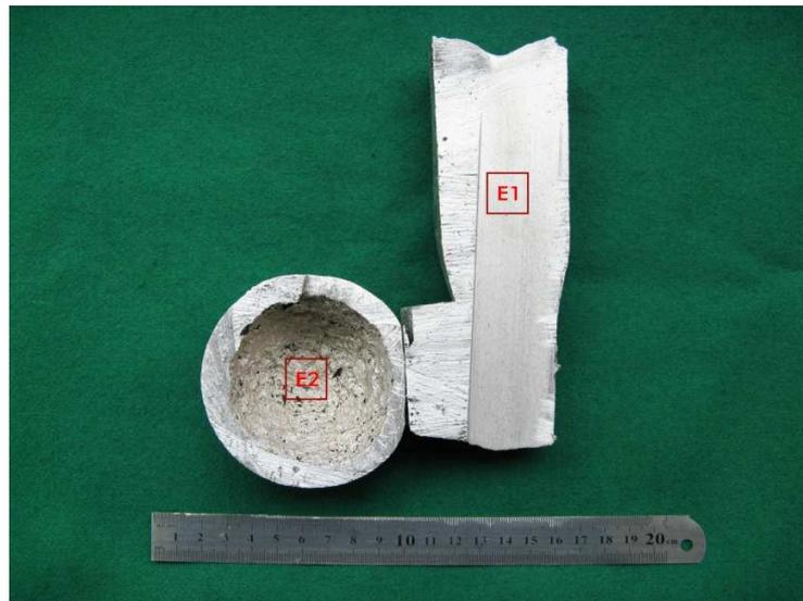
Figura 4.13 Identificación de la muestras en la sección transversal del sistema mazarota-esfera.
