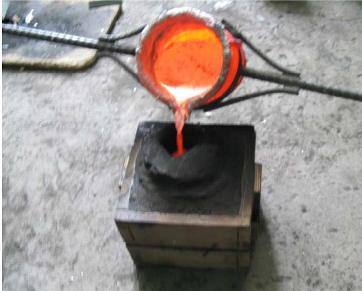
Figura 4.6 Colado del metal fundido
