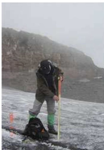
Figura 1.8 Medida de Ablación Glaciar sobre una estaca de Balance de masa glaciológico.
