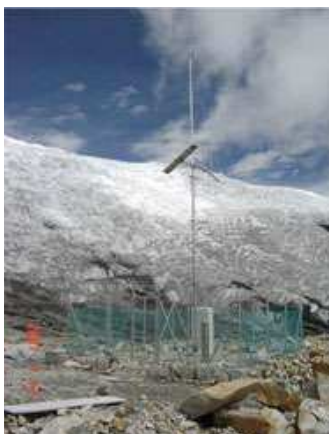
Figura 1.10 Estación Meteorológica automática satelital
