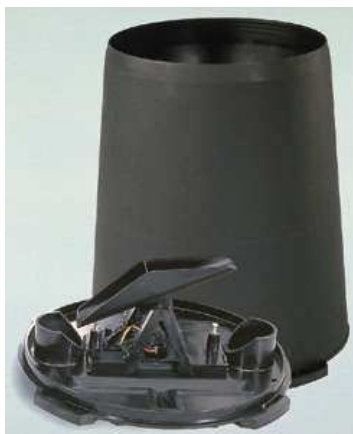
Figura 1.16 Pluviómetro de Precipitación
