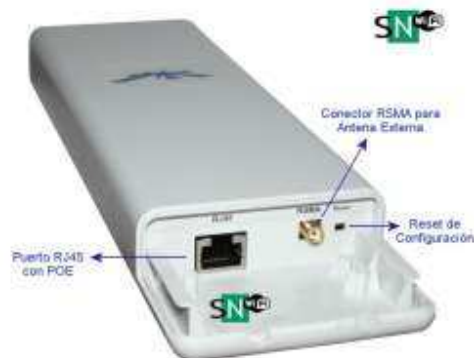
Figura 2.4 Parte posterior del Equipo y tipo de Conectores
