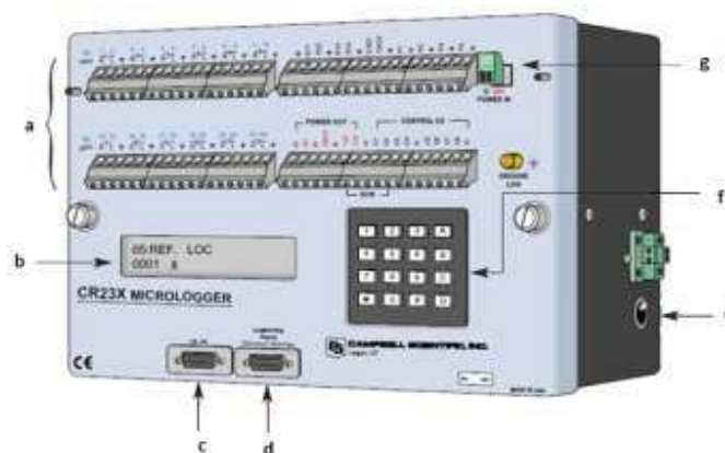
Figura 1.13 Descripción del Datalogger y sus componentes
