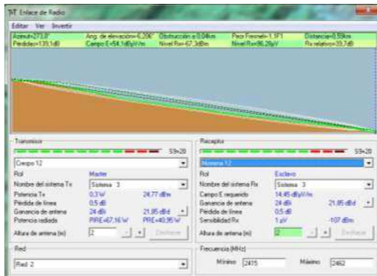
Figura 2.28 Enlace Crespo 12-Morrena 12 con antena externa
