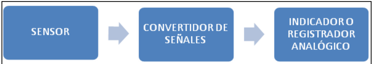
Figura 1.1 Diagrama de bloques de un instrumento de medición analógica [11]
