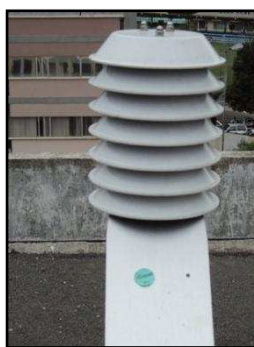
Figura 1.6 Sensor de humedad y temperatura del LEAEE de la Escuela Politécnica Nacional
