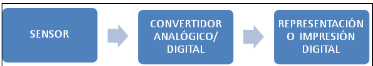
Figura 1.2 Diagrama de bloques de un instrumento de medición digital [11]
