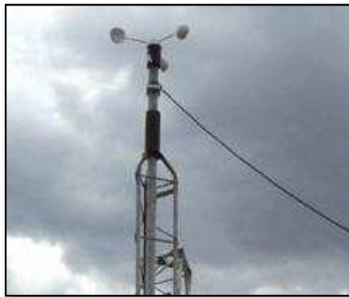
Figura 1.5 Taco Anemómetro DNA 001 del LEAEE de la Escuela Politécnica Nacional
