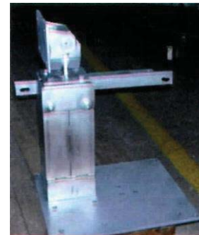
Fotografía 3. Estructura sistema inclinación
