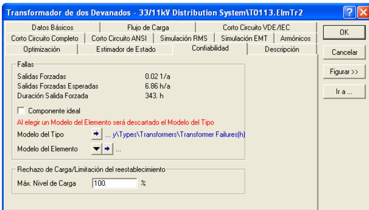
Figura 3.8 Datos de confiabilidad en transformadores
