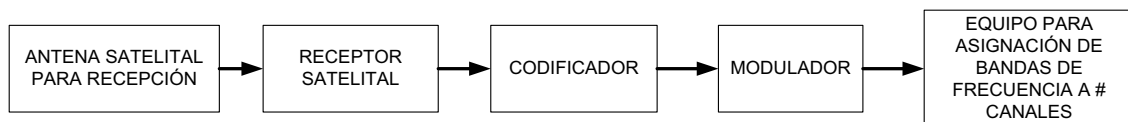
Figura 1.11: Diagrama de Bloques de canales recibidos a través de satélite para infraestructura analógica
