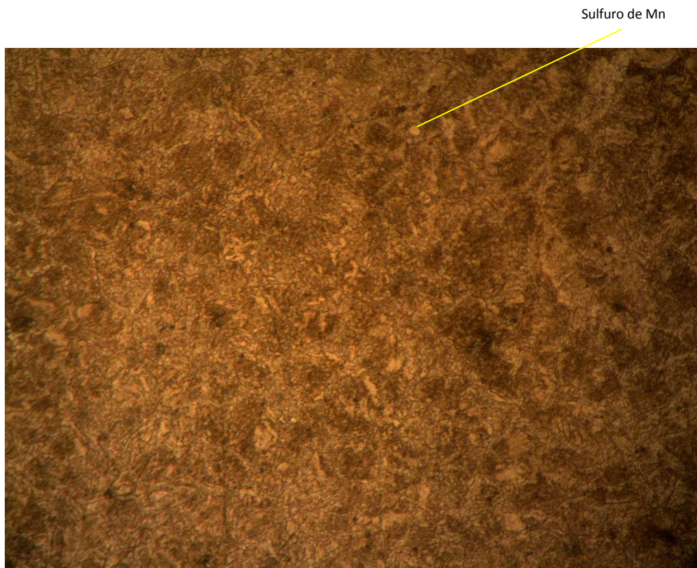
Figura 4.7 Acero AISI 1045, probeta 1.2 enfriada a 500° C. Matriz metálica ferrítico-perlítica. Se observa la presencia de perlita fina y sulfuros de Manganeso. 500X
