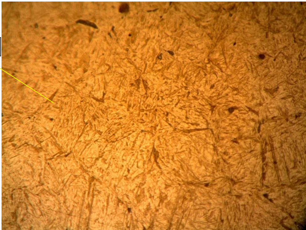
Figura 4. 38 Acero AISI 1070, probeta 2.5 enfriada en ACEITE. Acero de matriz metálica bainítica con placas de martensita. Se observa inclusiones tipo silicato. 500x
