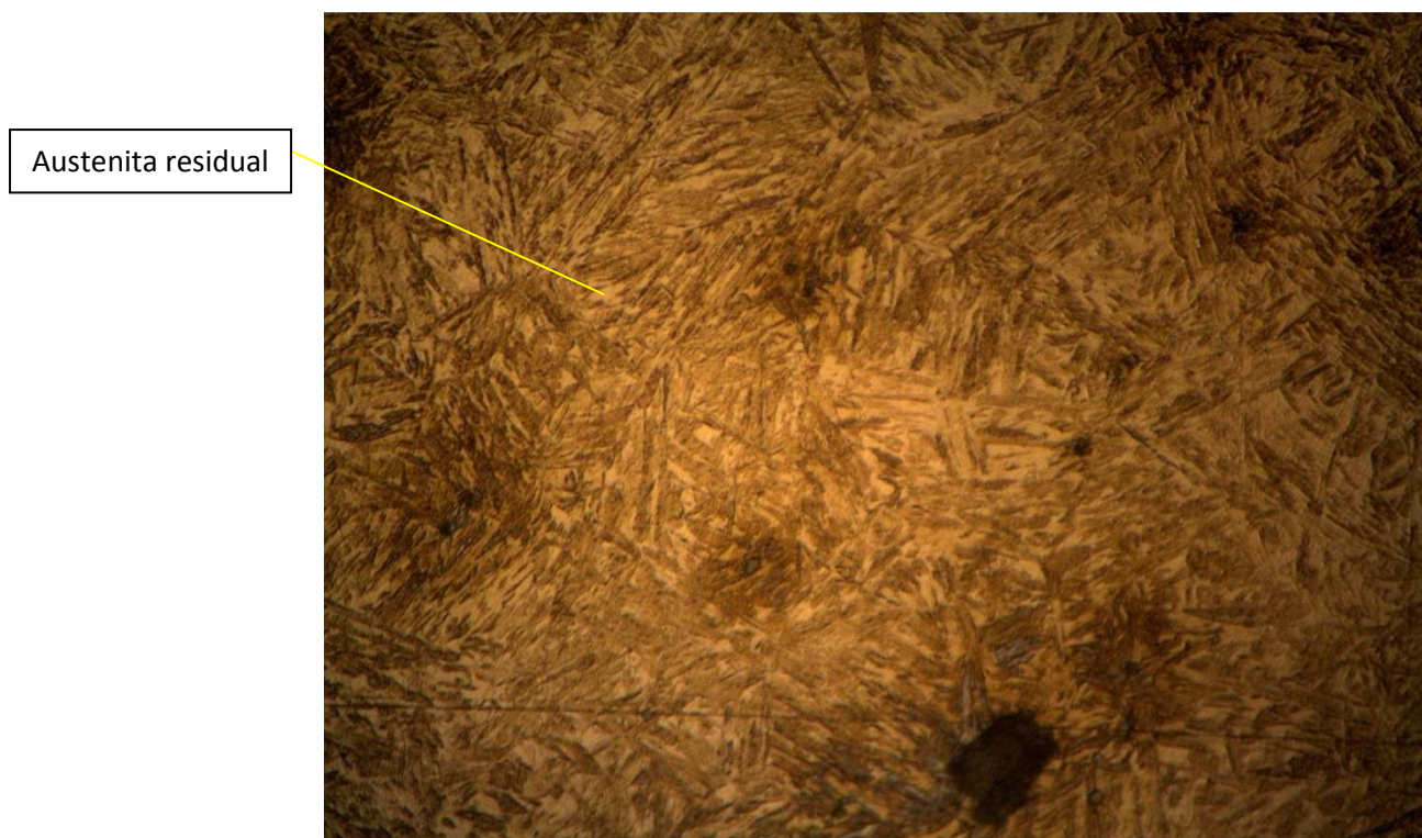
Figura 4.20 Acero AISI 1045, probeta 1.6 enfriada en AGUA. Se observan las agujas martensíticas y austenita residual. 1000X
