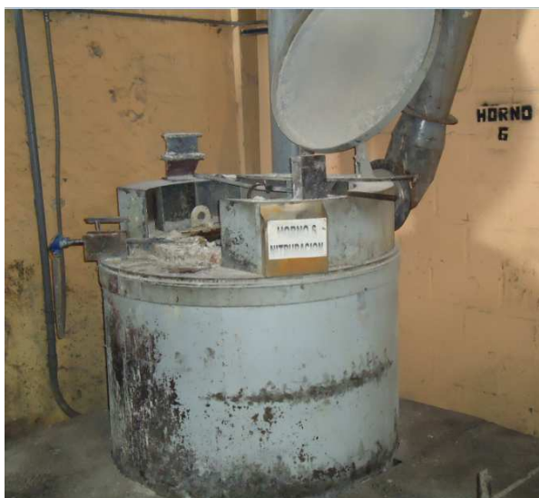
Figura 3. 20 Horno N5 para enfriamiento isotérmico a 380°C.
