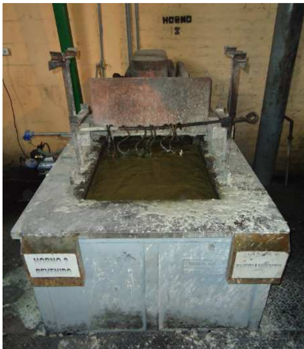
Figura 3. 21 Horno N°2 para enfriamiento isotérmico a 200°C.
