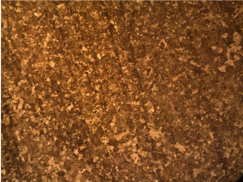
Figura 4. 31 Acero AISI 1070, probeta 2.3 enfriada 380^{\circ} . Acero perlítico, tratado térmicamente. Se observan zonas bainíticas y segregación de segundas fases. Tamaño de grano ASTM No 9. 100X
