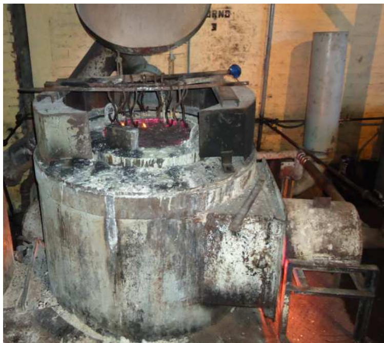
Figura 3.17 Horno N°3 para calentamiento hasta temperatura de austenización.
