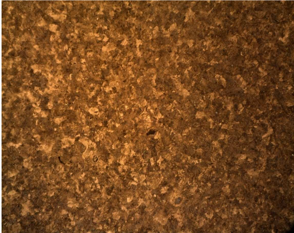
Figura 4.43 Acero AISI 1070 probeta 2.7 enfriada en AIRE. Acero ferrítico-perlítico, tratado térmicamente. Se observa la presencia de inclusiones tipo Silicato. Tamaño de grano ASTM No 9. 100X
