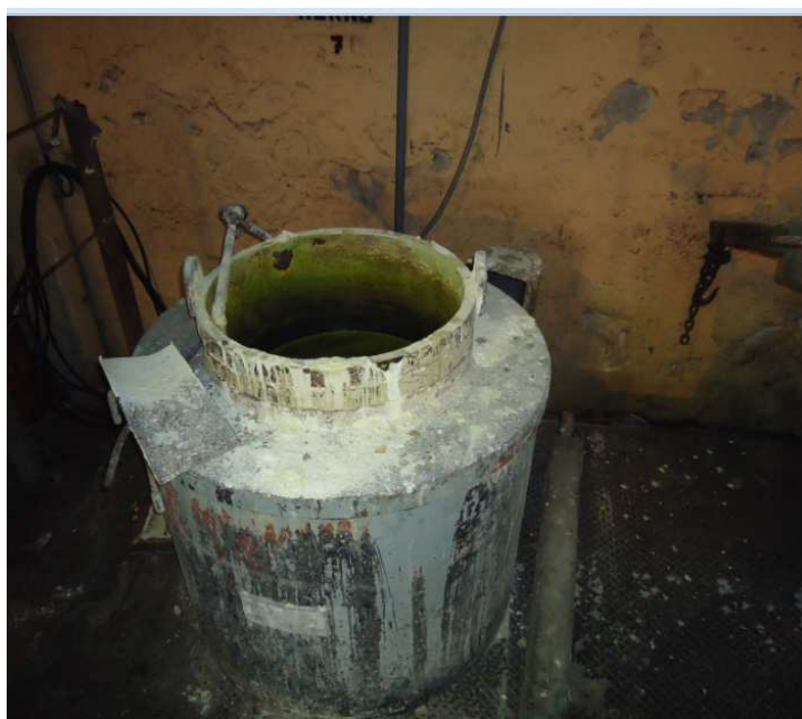
Figura 3. 18 Horno N°7 para enfriamiento isotérmico a 600 °C.
