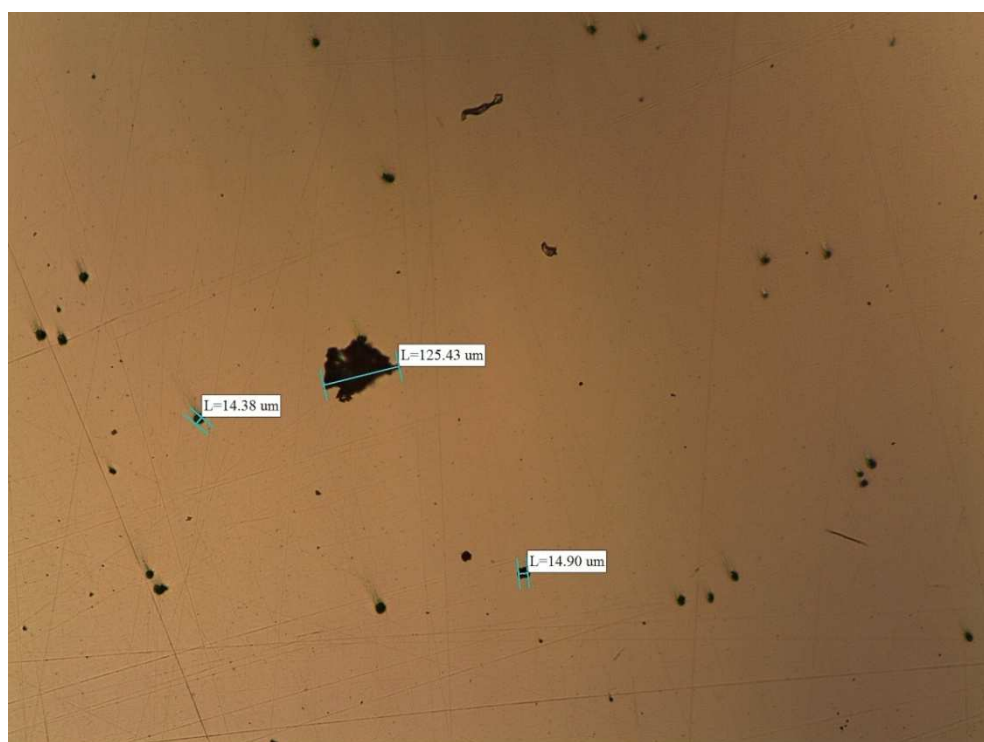
Figura 4. 42 Acero AISI 1070 probeta 2.7 enfriada en AIRE. Se observan inclusiones tipo silicato, la mayor de ellas con una dimensión de 125,43 μm. 100X
