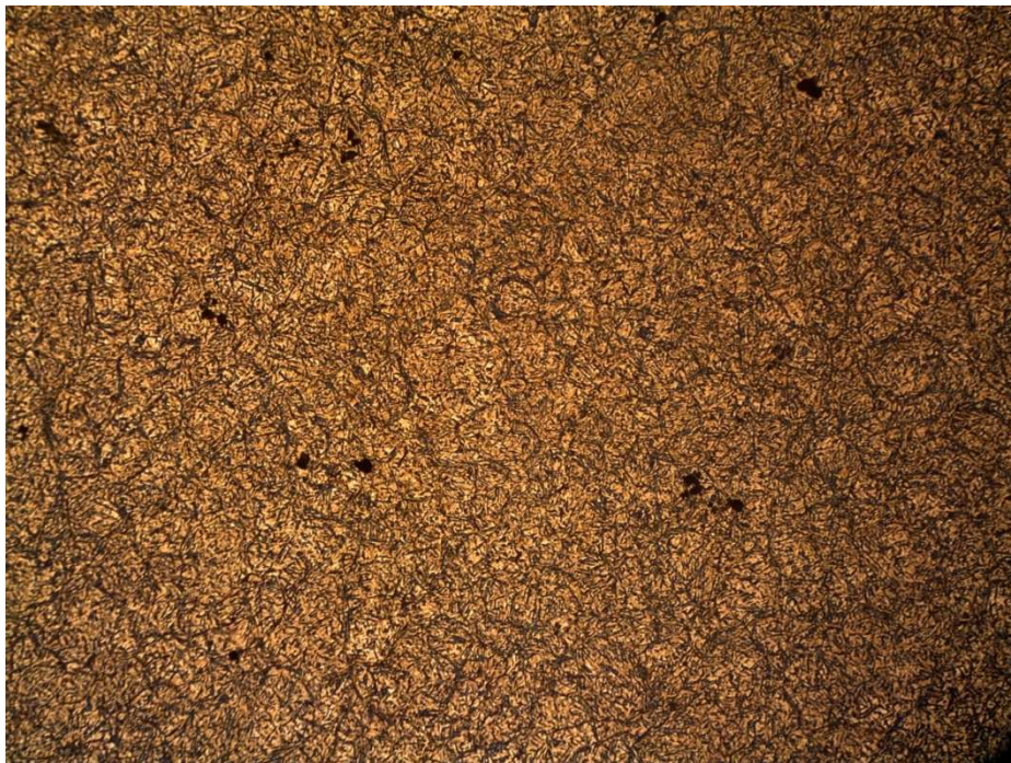
Figura 4.34 Acero AISI 1070, probeta 2.4, enfriada a 200° C. Acero bainítico, tratado térmicamente. Se observan inclusiones tipo silicato. 100X
