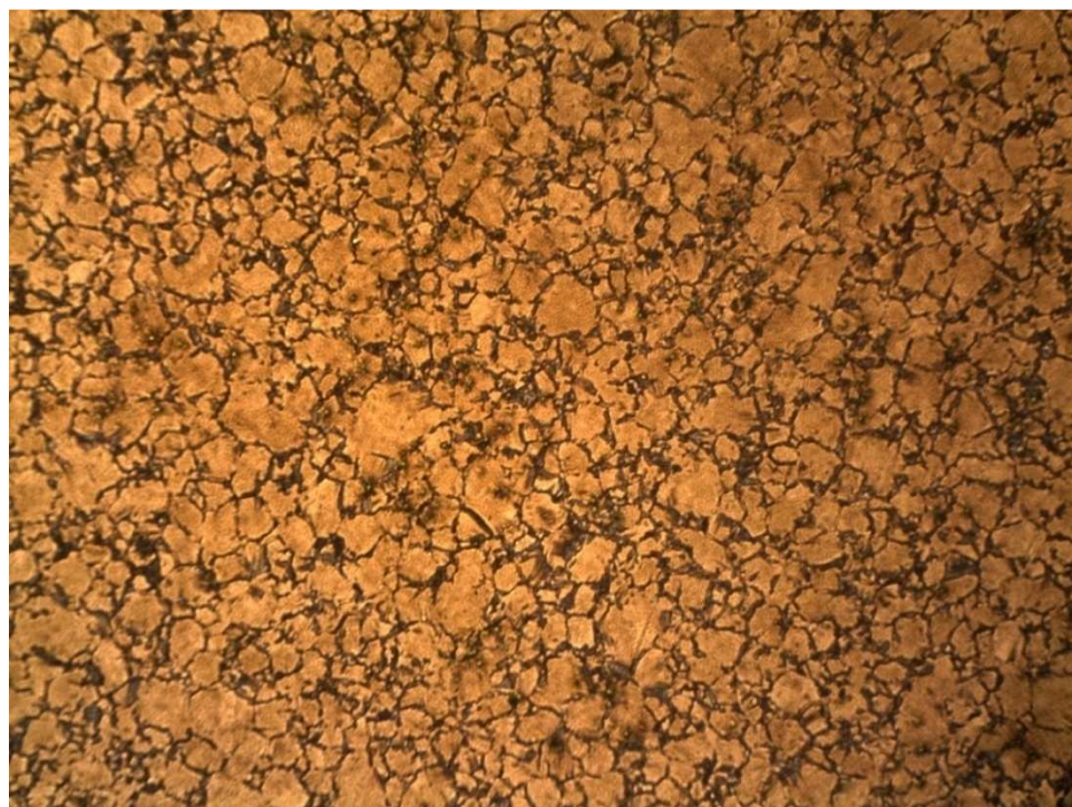
Figura 4.12 Acero AISI 1045, probeta 1.4 enfriada 200° C. Acero bainítico tratado térmicamente, con Carburos de Cromo precipitados al borde de grano. Se observan inclusiones tipo silicato. Tamaño de grano ASTM No 9. 100X
