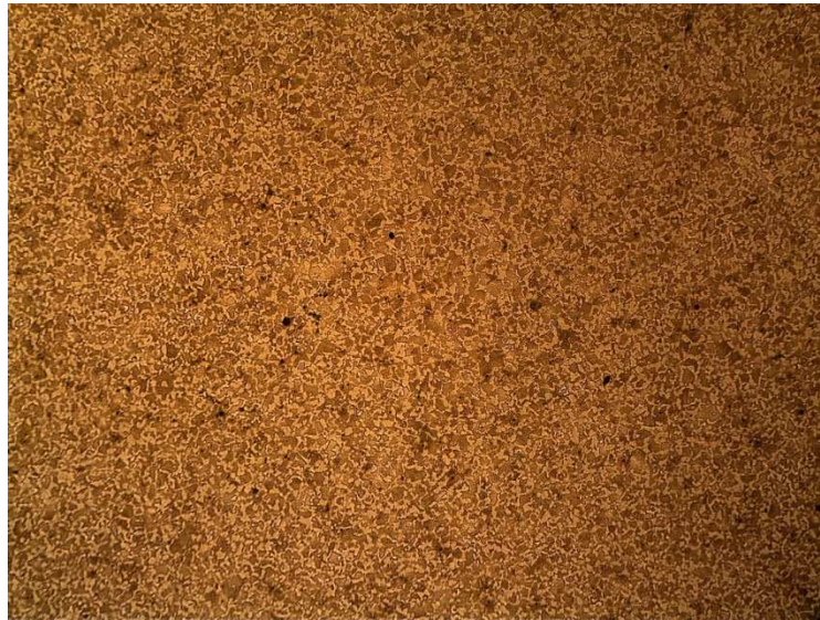
Figura 3.9 Acero AISI 1045. Probeta en condiciones de suministro. Acero ferrítico-perlítico de contenido medio de Carbono. Se observan inclusiones tipo silicato. Tamaño de grano ASTM No 8. 100X.
