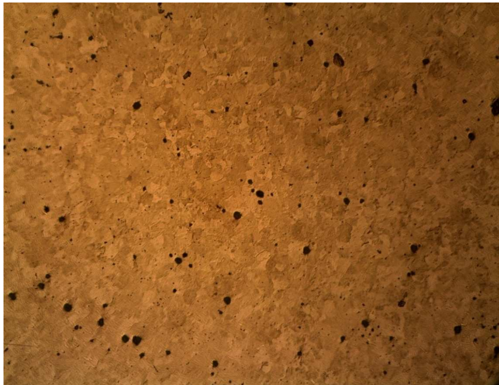
Figura 4.25 Acero AISI 1070, probeta 2.1 enfriada a 600° C. Acero perlítico, tratado térmicamente. Se observa una gran cantidad de inclusiones tipo silicato. Tamaño de grano ASTM No 9. 100X
