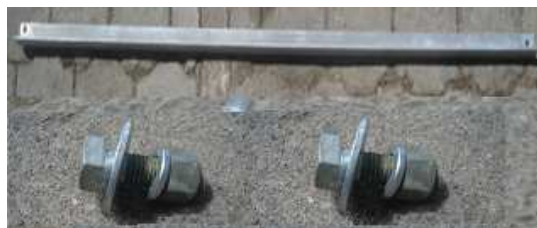
Figura 2.17 Pie amigo de perfil tipo "L" y pernos máquina
