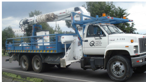
Figura 3.3 Camión grúa con equipo barreno
