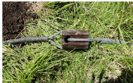
Figura 3.52 Entorches en el aislador de retenida
