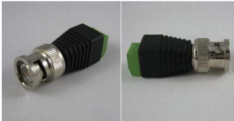
*Figura 2. 24 Balun UTP pasivo para video cámaras de CCTV [34].*
