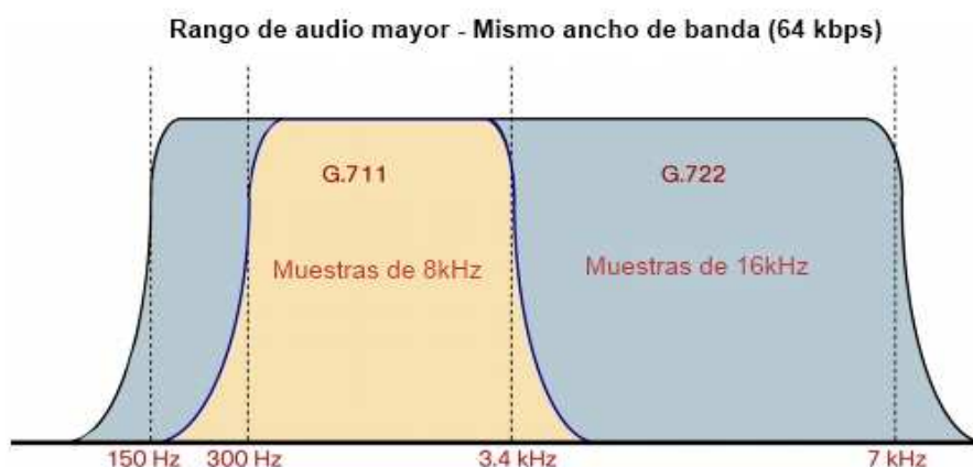
Figura 2.17 Rangos de frecuencia de banda estrecha y banda ancha
