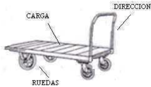
Fig. 1.2. Plataforma con rodajas tipo no inclinable.
