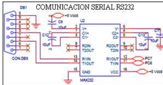
Figura 2.23. Conexi n Serial RS232.
