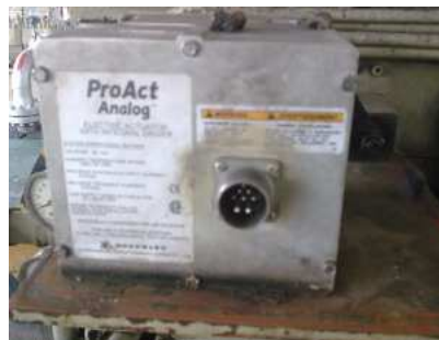
Figura 1.15 Motor eléctrico del gobernador de velocidad
