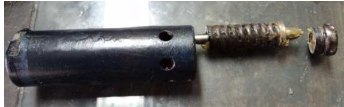
Figura 1.14 Válvula de seguridad de las botellas de aire comprimido
