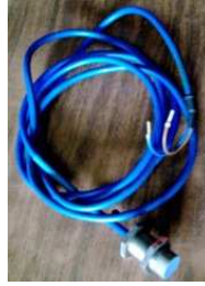
Figura 2.6 Detector de proximidad inductivo para detectar el acoplamiento motor-bomba
