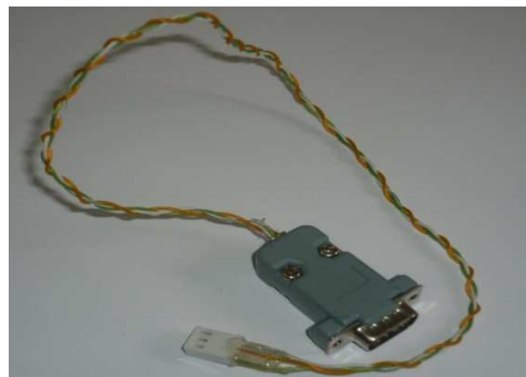
FIGURA 1.11 Conexión Modem - Microcontrolador
